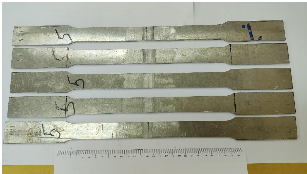
Slika 10. Ispitni uzorci za vlačno ispitivanje
