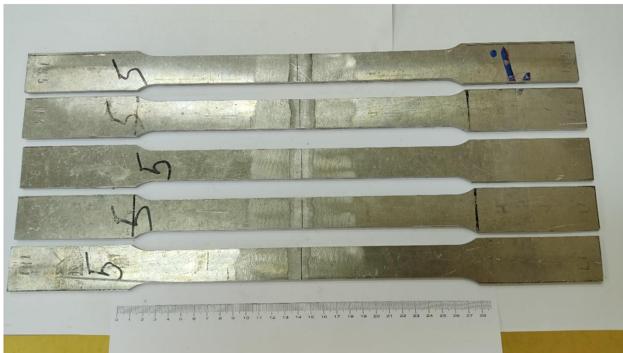
Slika 10. Ispitni uzorci za vlačno ispitivanje
