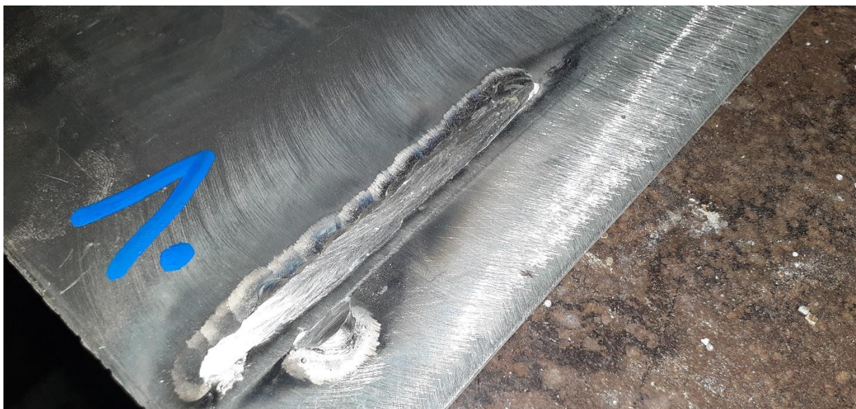
Slika 9. Ostaci zavarenog spoja
