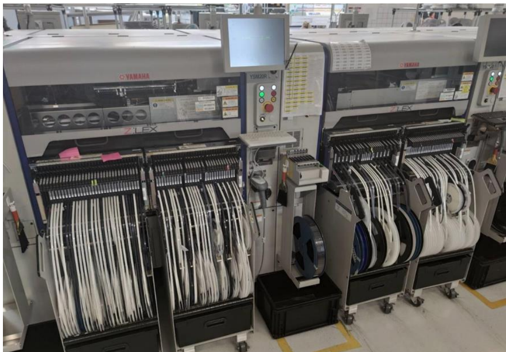
Slika 6: SMD linija za proizvodnju tiskanih ploča
