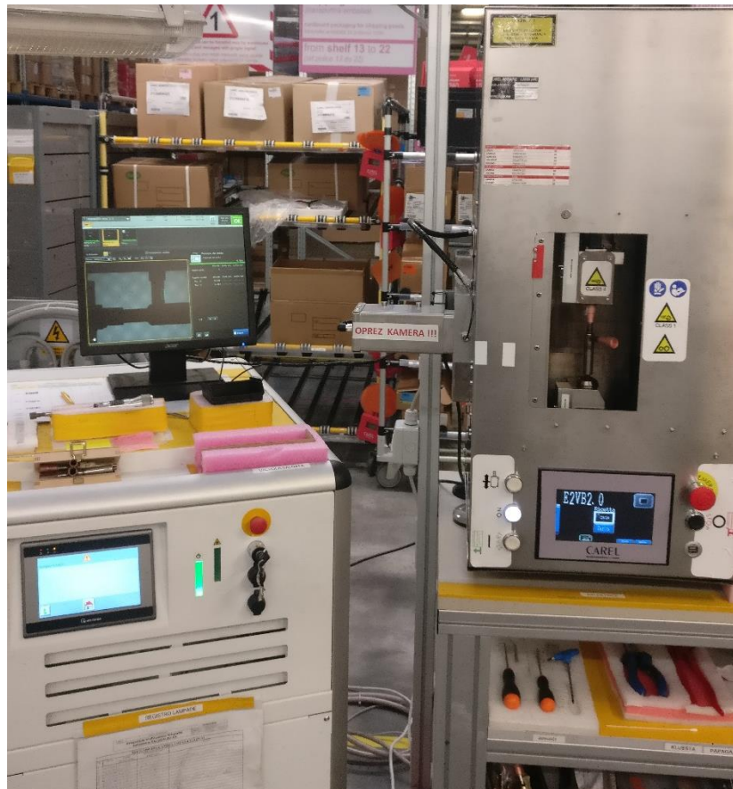
Slika 12: Izvor lasera i stroj za zavarivanje
