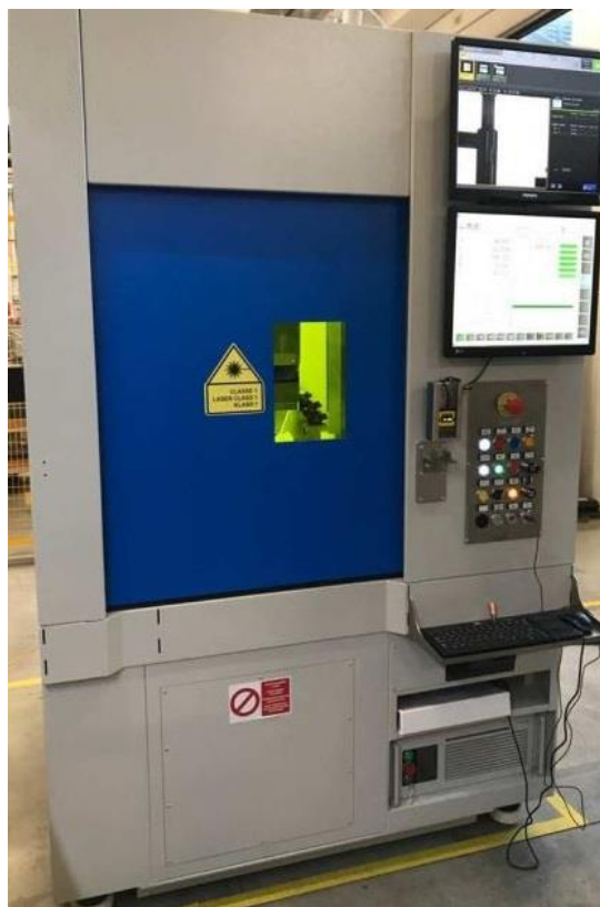
Slika 13: Stroj za zavarivanje s optičkim laserskim izvorom
