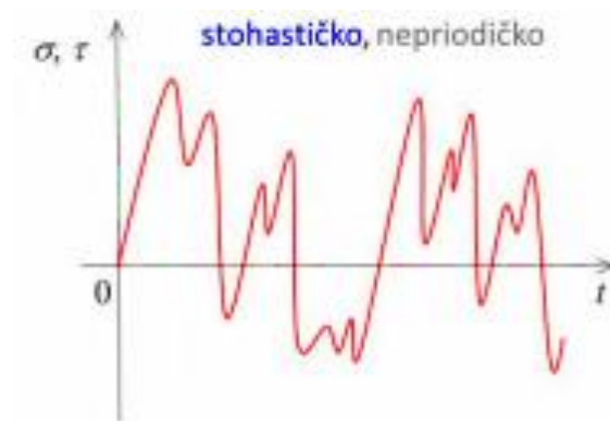
Slika 9. Neperiodička dinamička opterećenja (Munjias N., 2020.)
