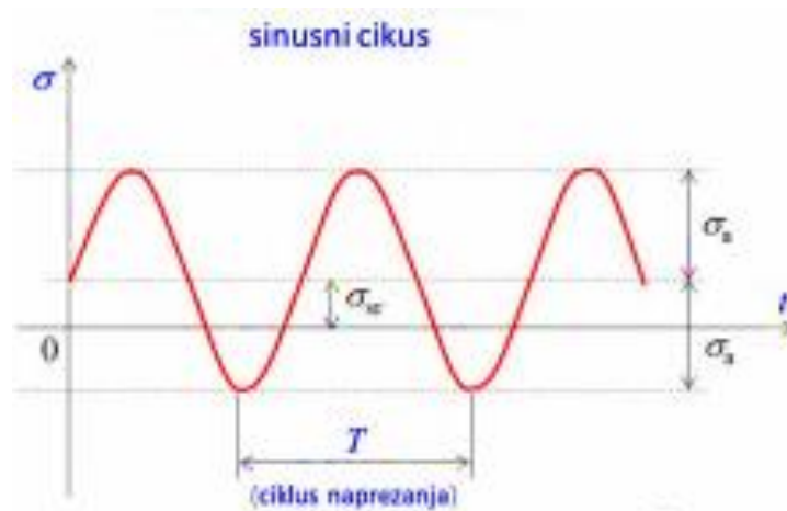
Slika 11 – Harmonička dinamička opterećenja (Munjas N., 2020.)
