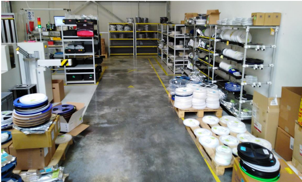
Slika 18. Ostavljene SMD komponente na podu
