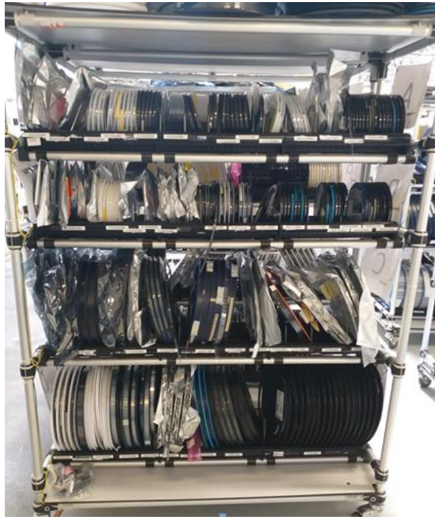
Slika 20. Optimizirane stalaže za komponente različitih veličina
