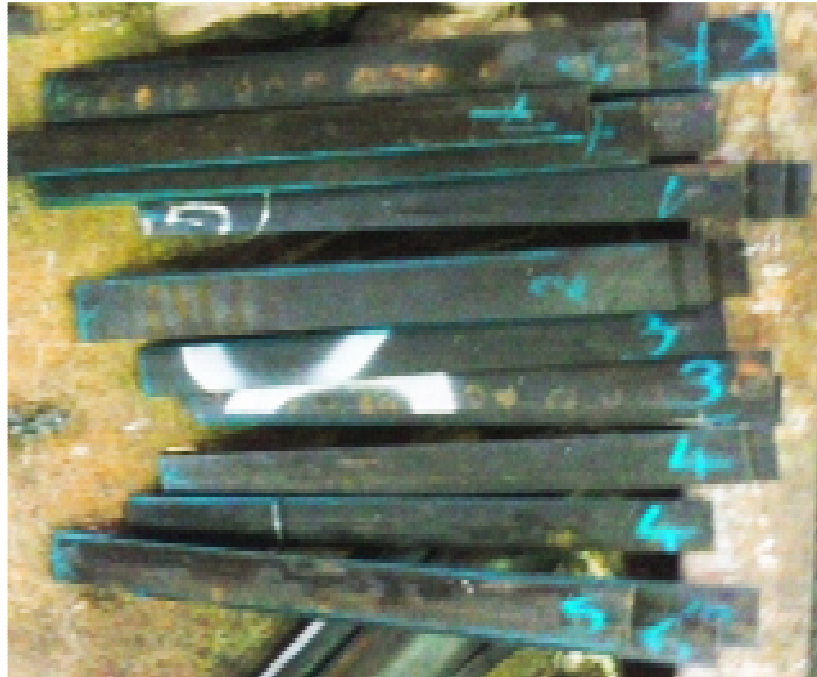
Slika 5. Dijelovi cijevi za izradu epruvete za statičko vlačno ispitivanje cijevi
