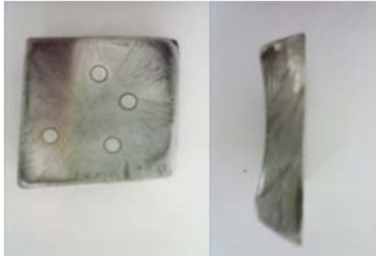
Slika 8. Epruveta za kemijsko ispitivanje
