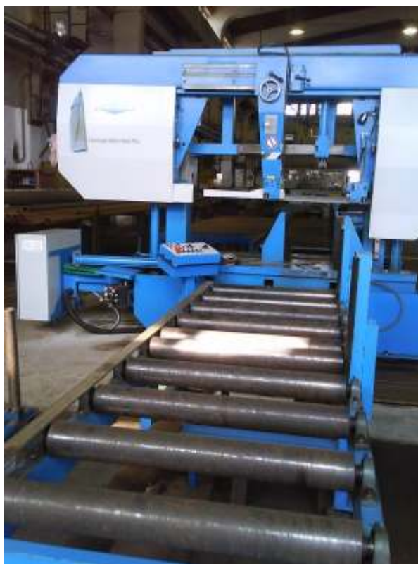
Slika 10. Tračna pila JAESPA 800/1000PG
