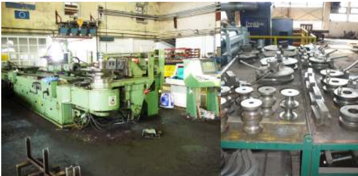
Slika 14. Savijačica i pripadajući kalupi za savijanje
