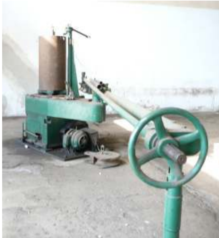
Slika 17. Savijačica cijevi-serpentina cilindrična
