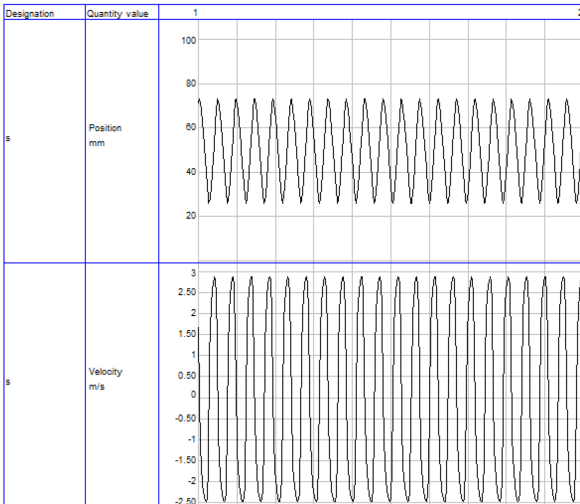
Slika 43. Dijagram sustava podešen Ziegler-Nichols metodom
