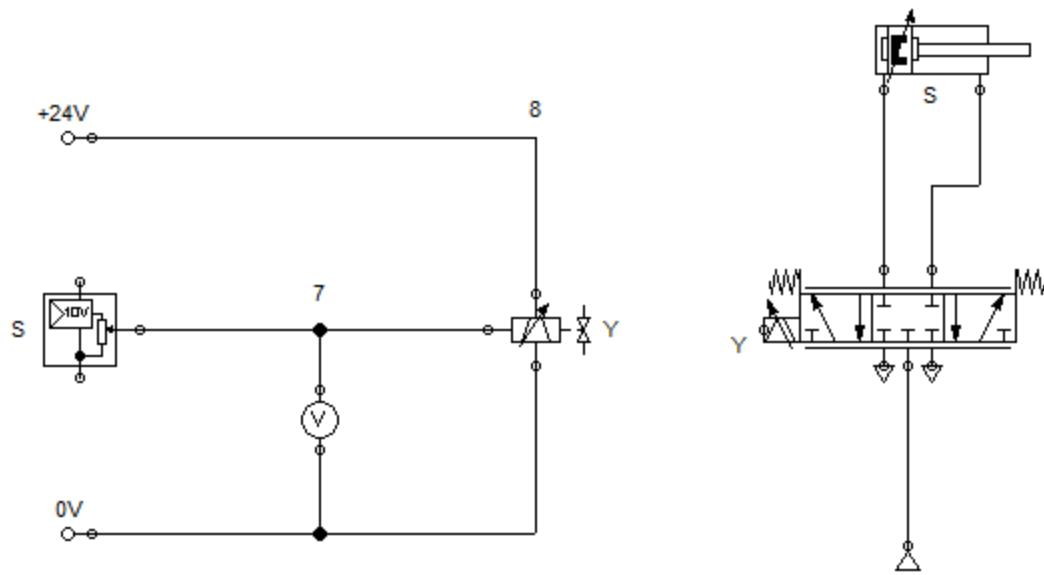
Slika 35. Jednostavni sklop za kontrolu položaja pneumatskog cilindra
