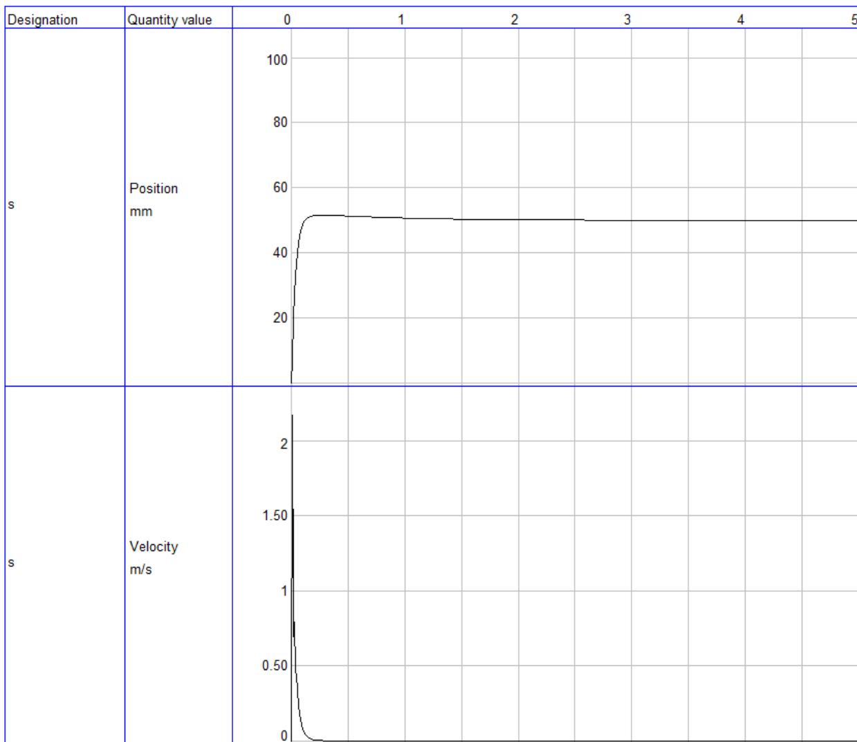
Slika 37. Dijagram stanja s podešenim PID parametrima
