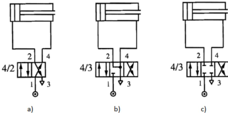
Slika 30. Energetski sklop dvoradnog cilindra s: a) 4/2 razvodnikom, b) 4/3 razvodnikom s otvorenim srednjim položajem, c) 4/3 razvodnikom s zatvorenim srednjim položajem
