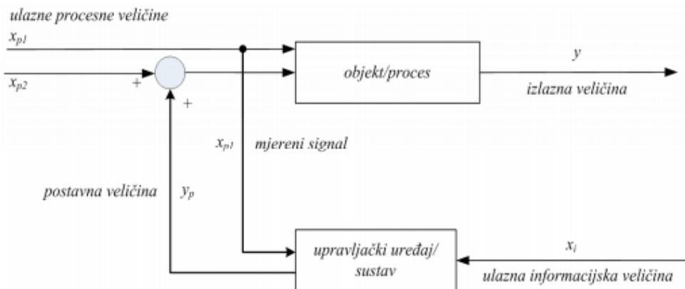
Slika 4. Blok dijagram unaprijednog upravljanja
