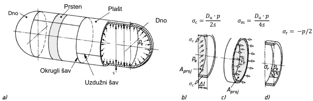
Slika 2: Naprezanja na omotaču spremnika zbog unutarnjeg pritiska  $p$ . a) posuda pod tlakom kao zatvoreni šuplji cilindar, b) cirkularno naprezanje  $\sigma_c$ , c) meridijalno naprezanje  $\sigma_m$ , d) radikalno naprezanje  $\sigma_r$ ; izvor: Wittel i sur., 2017., str. 189.
