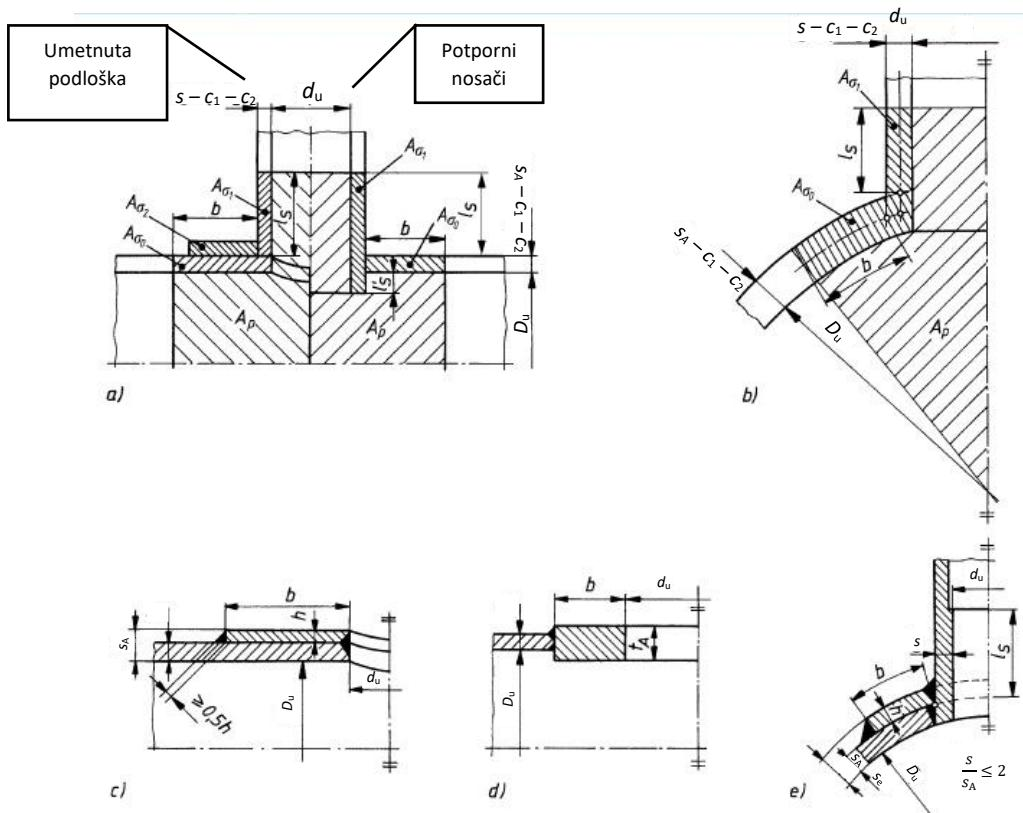
Slika 8: Izrezi na posudi pod tlakom; a) i b) Proračunska shema za cilindrična i sferna osnovna tijela; c) Primjenjena armatura; d) Umetnuta armatura (prirubnica); e) cijevna armatura u obliku diska; izvor: Wittel i sur., 2017., str. 194.
