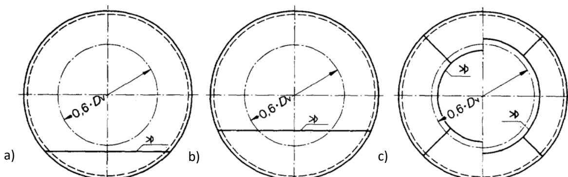
Slika 6: Pozicija zavarenog šava na podnici posude pod tlakom; a) šav je izvan  $0,6 D_v$ ,  $v = 0,85$  ili  $1,0$ ; b) šav je unutar  $0,6 D_v$ ,  $v = 1,0$ , c) Podnica od zaobljene ploče i segmenata u zavarenoj izvedbi, lijevo  $v = 1,0$ , desno  $v = 0,85$  ili  $1,0$ ; Izvor: AD 2000
