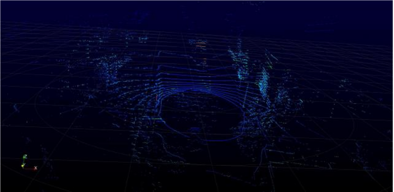
Slika 7: Prikaz sirovih podataka na senzoru (3D) Izvor: H. Sjafric (2019.): Introduction to Self-Driving Vehicle Technology
