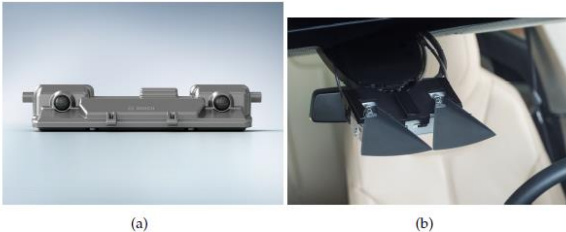
Slika 10: a) Bosch stereo video kamera, b) Lokacija kamere na prednjem staklu Izvor: H. Sjafric (2019.): Introduction to Self-Driving Vehicle Technology
