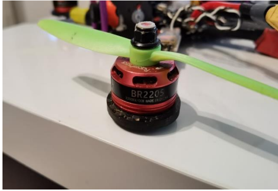
Slika 18. Motor RacerStar BR2205
