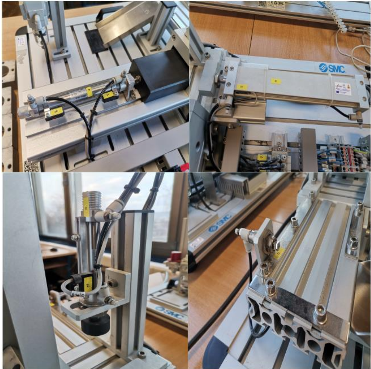
Slika 19 Prikaz cilindara A, B, C i D te njihovih odgovarajućih senzora a0, a1, b1 i c1 Izvor: Autor
