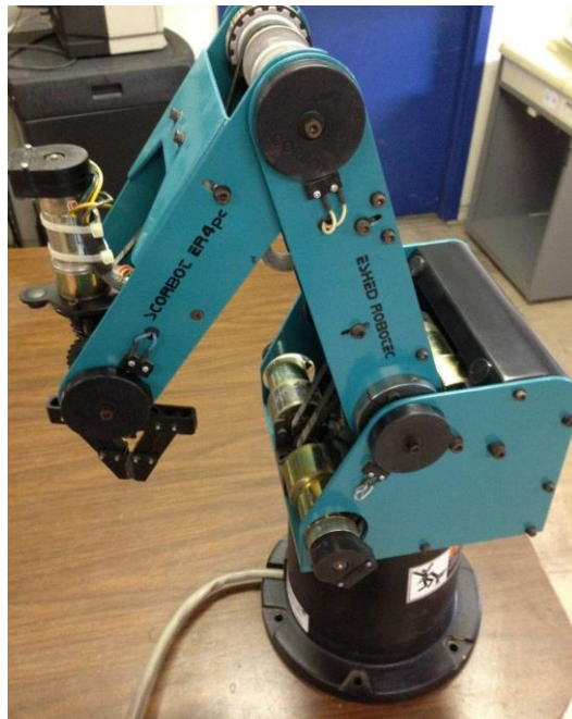
Slika 16 Prikaz Scorbase robota sa elektroničkim sustavom
