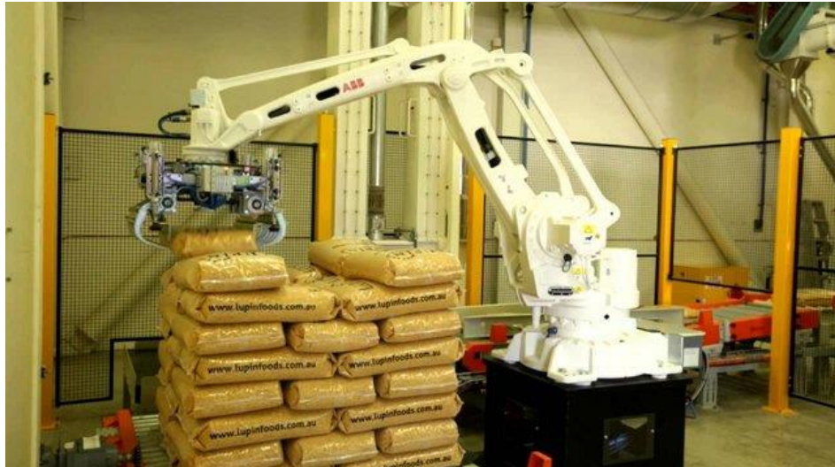
Slika 11 Prikaz industrijskog robota paletizera Izvor: https://pbs.twimg.com/media/C2INa1yXEAAyuMr.jpg Preuzeto 16.03.2021
