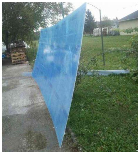
**Slika 7. Ploča poli(metil-metakrilata)**
