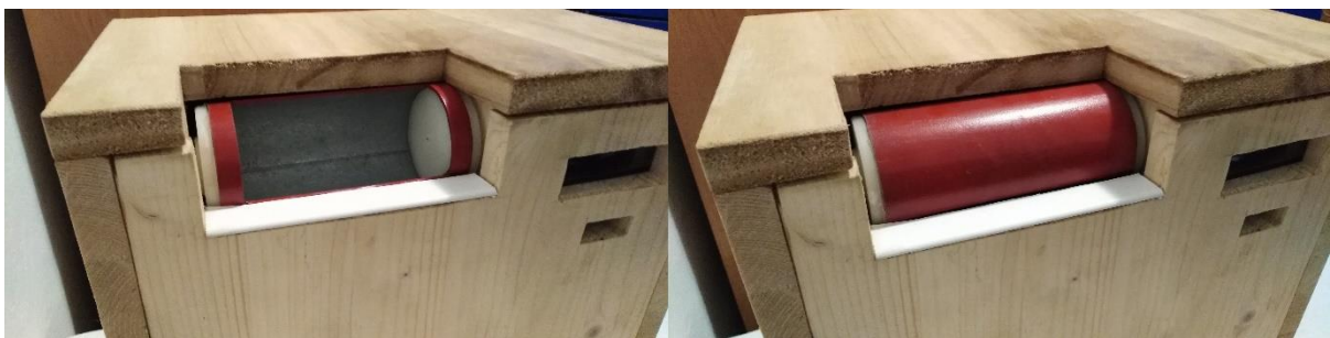
Slika 22. Pretinac za ubacivanje otpada (Izradio Autor)
