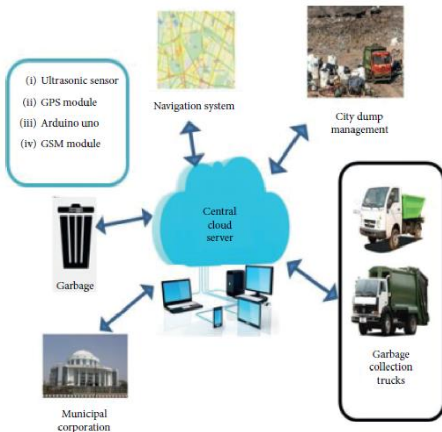
Slika 4. Arhitektura IoT sustava za gospodarenje otpadom (Aniqa Bano, Ikram Ud Din, Asma A. Al-Huqaquil , 2020.)
