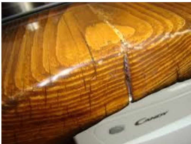
Slika 9. Greška pucanja u dasci
