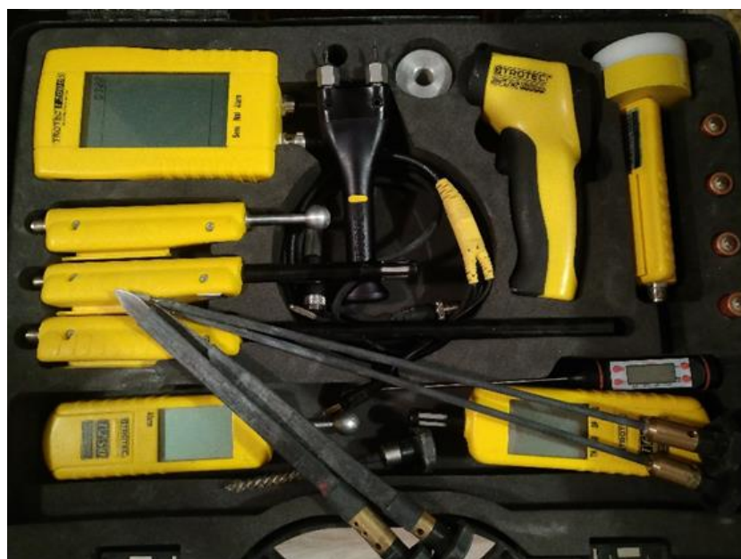
Slika 13: Mjerni instrument Trotec T2000 s mjernim elektrodama i sondama (Autor).
