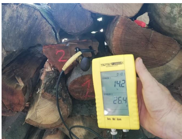
Slika 24: Mjerenje vlage bukove metrice. (Autor).
