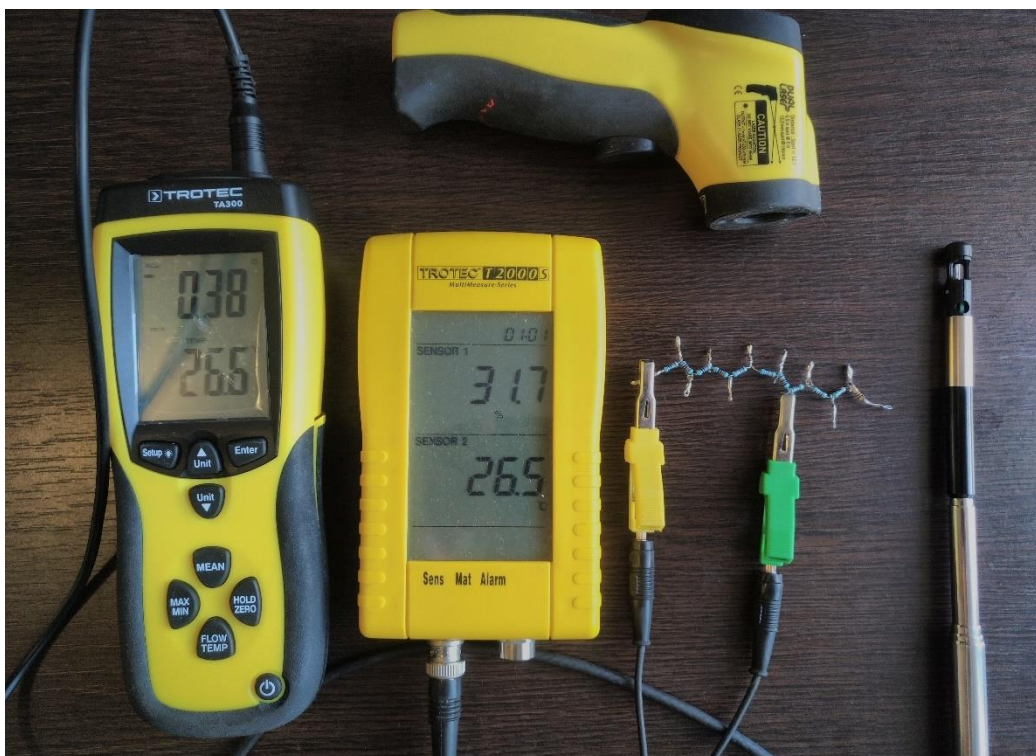
Slika 22: Ispitivanje utjecaja temperaturne korekcije Trotec T2000 (Autor).
