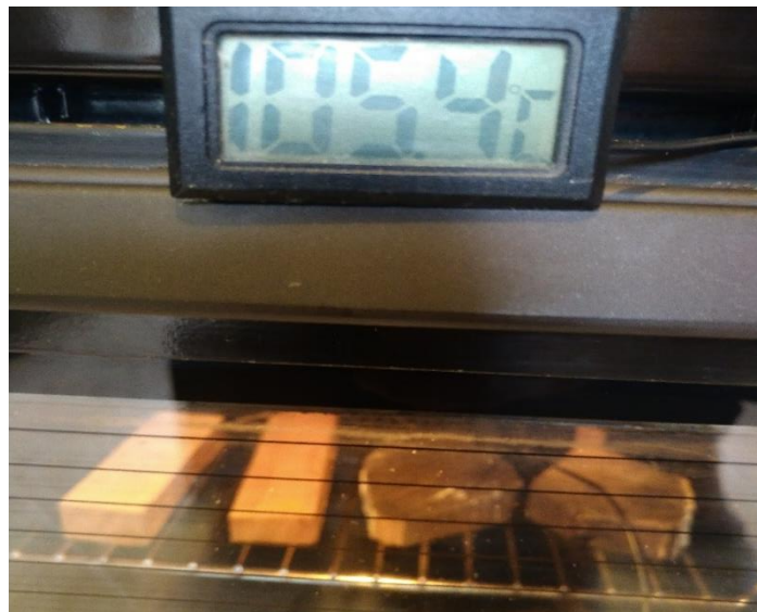
Slika 34: sušenje uzoraka uz praćenje temperature (Autor).
