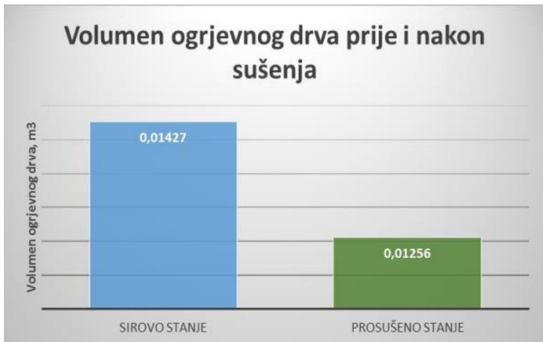
Slika 9: Grafički prikaz promjene volumena ogrjevnog drveta [11].
