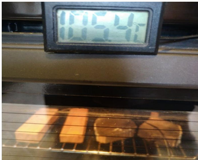
Slika 34: sušenje uzoraka uz praćenje temperature (Autor).
