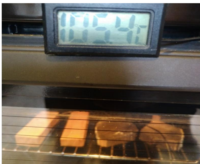
Slika 34: sušenje uzoraka uz praćenje temperature (Autor).
