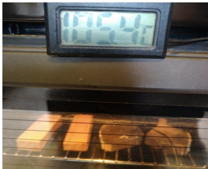
Slika 34: sušenje uzoraka uz praćenje temperature (Autor).
