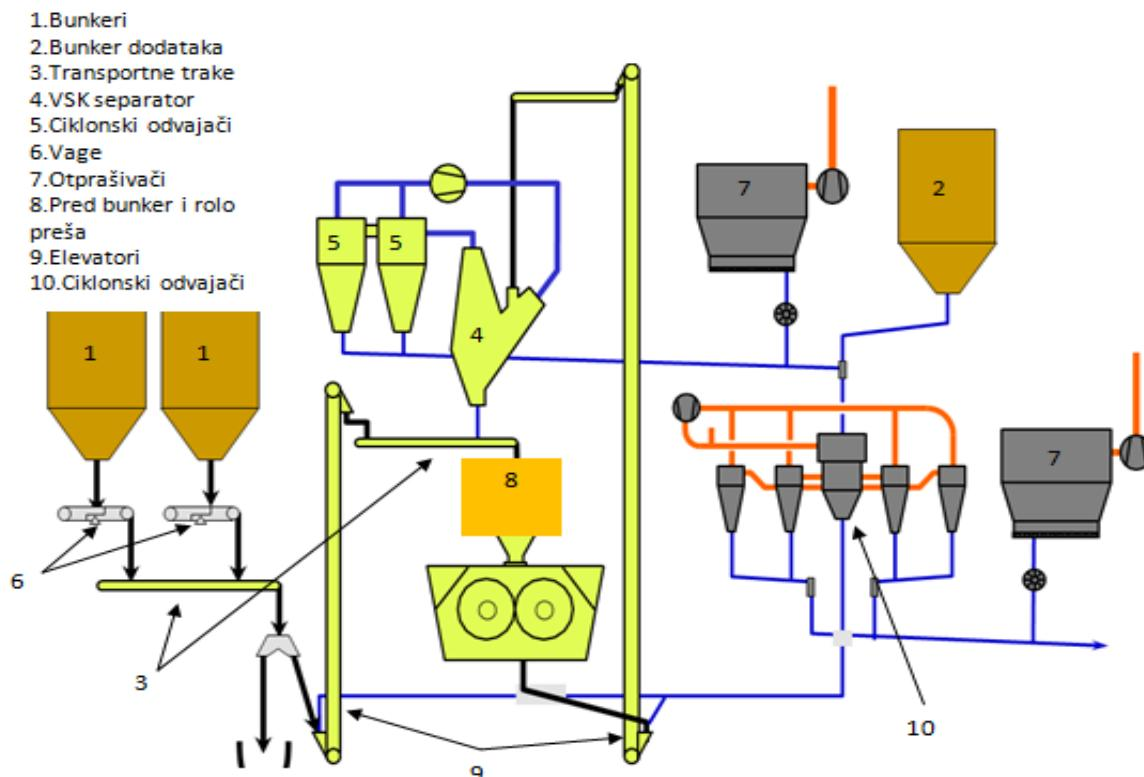
Slika 2. Shematski prikaz Transporta sirovine<sup>8</sup>
