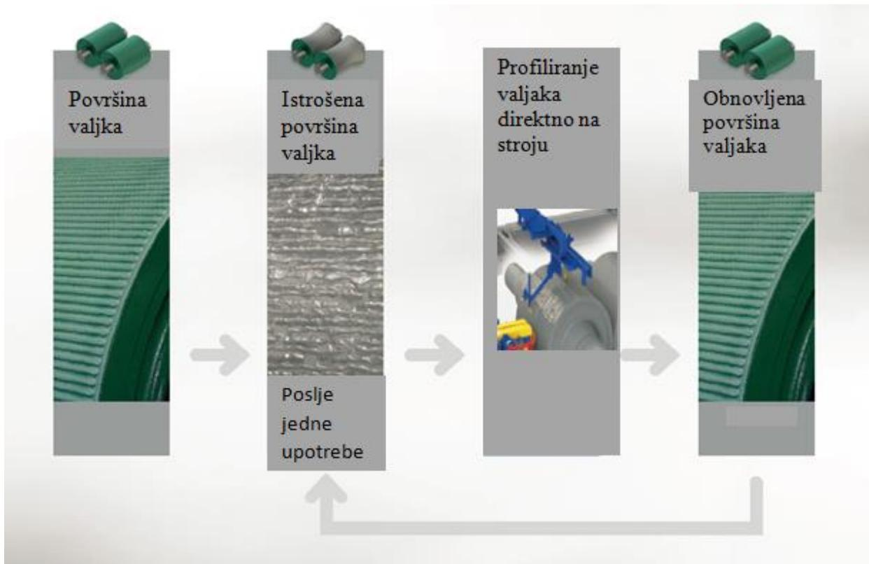
Slika 12. Obnavljanje valjaka profiliranjem<sup>20</sup>
