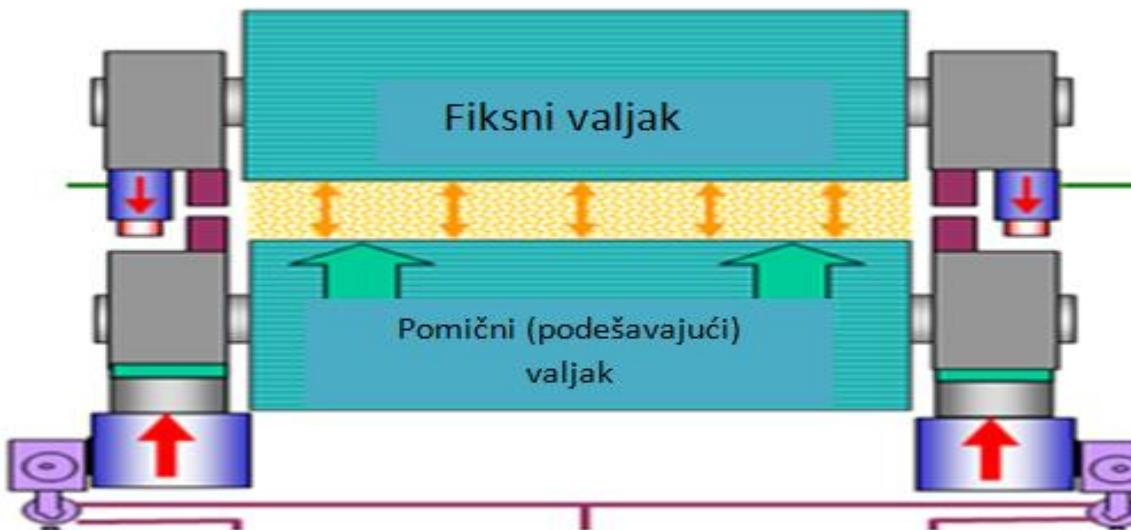
Slika 6. Princip rada sile između valjaka rolo preše<sup>13</sup>
