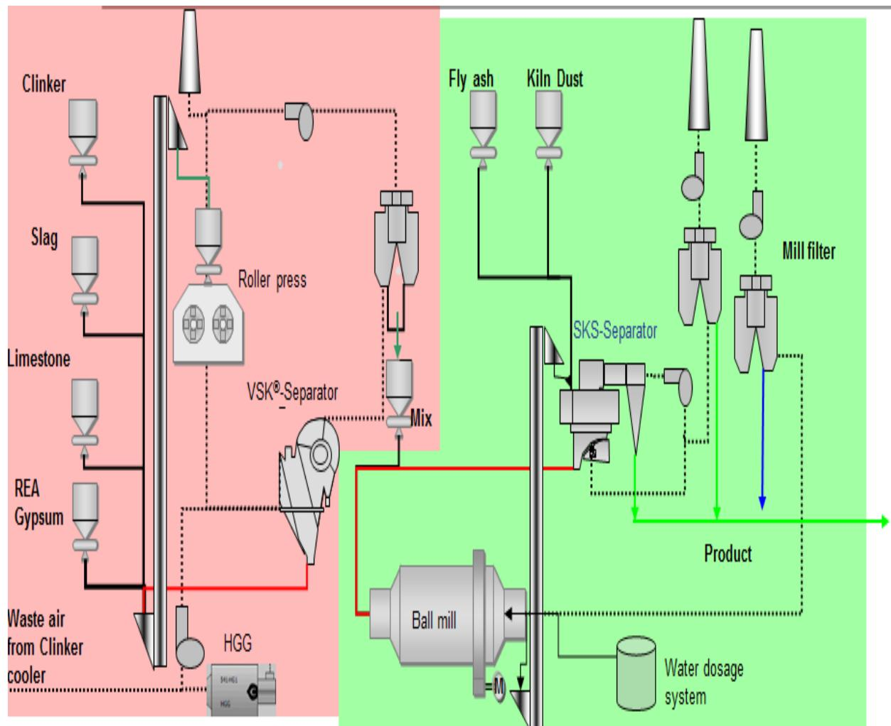
Slika 3. Shematski proces mljevenja sirovine (cementna) u dva stupnja<sup>10</sup>
