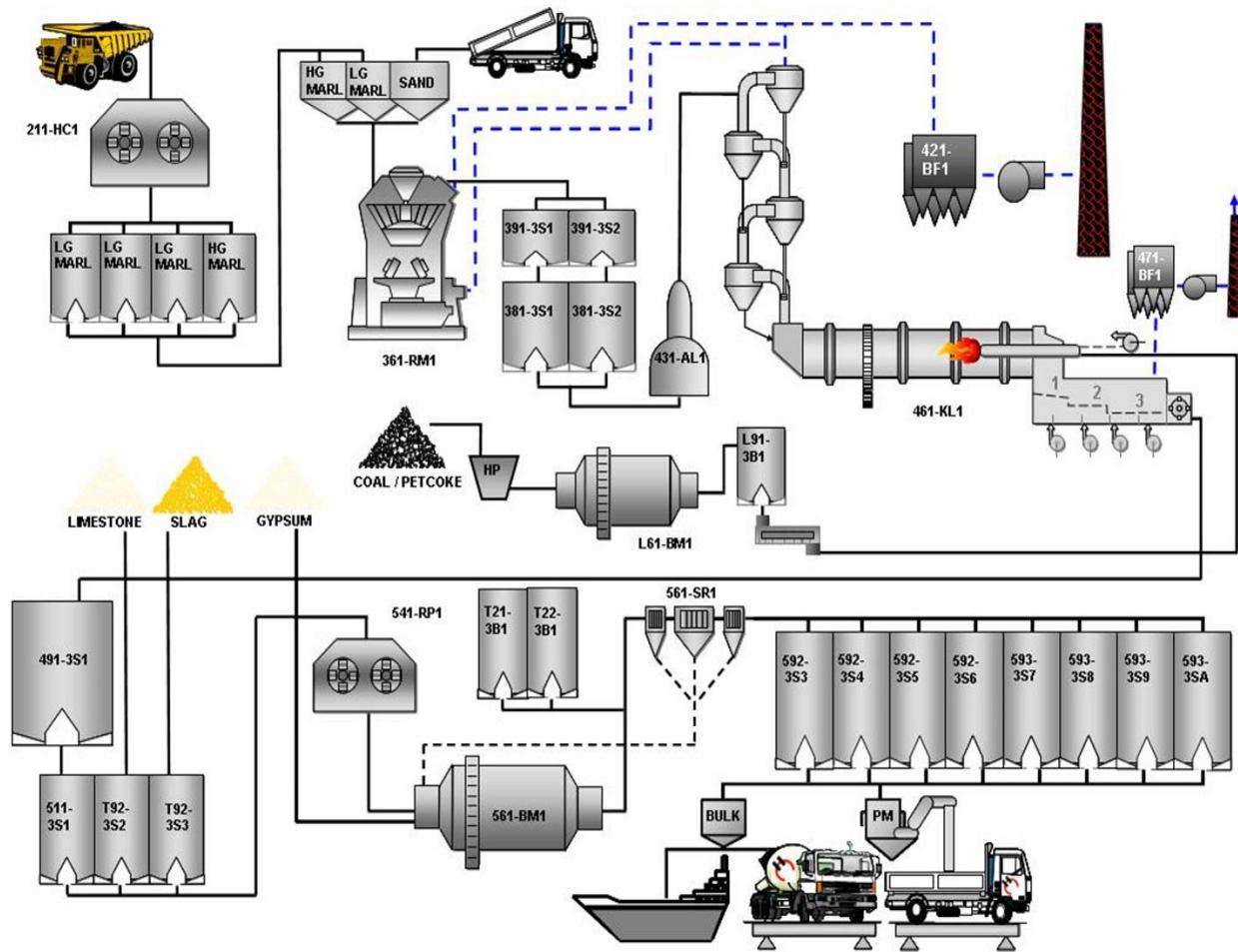
Slika 1. Shematski prikaz proizvodnje cementa
