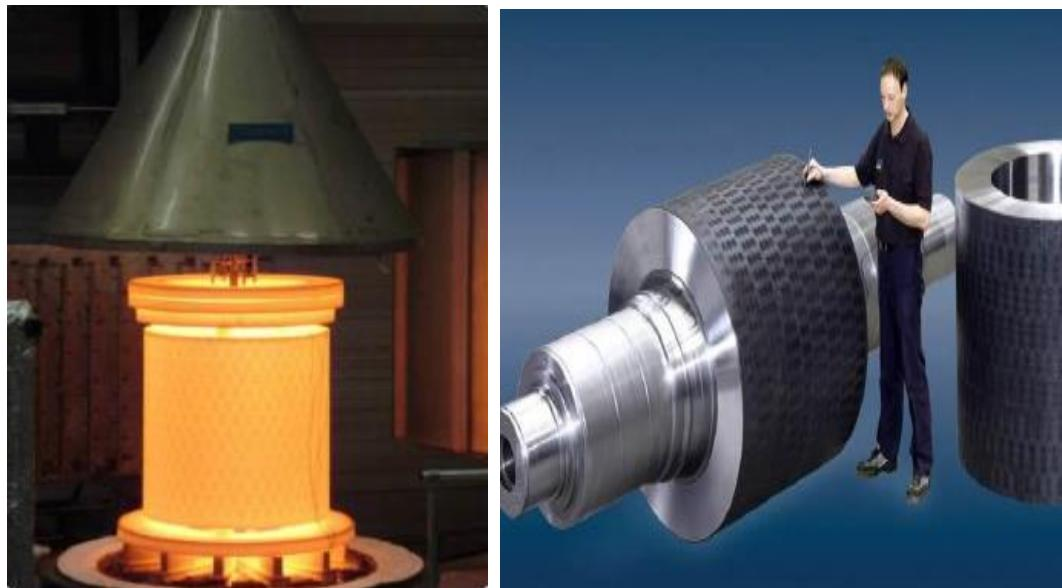
Slika 19. Završna obrada i testiranje valjka<sup>29</sup>
