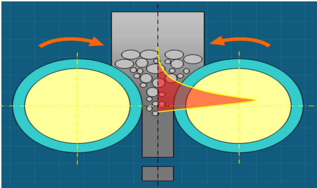
Slika 7.Princip rada sile između valjaka rolo preše<sup>14</sup>
