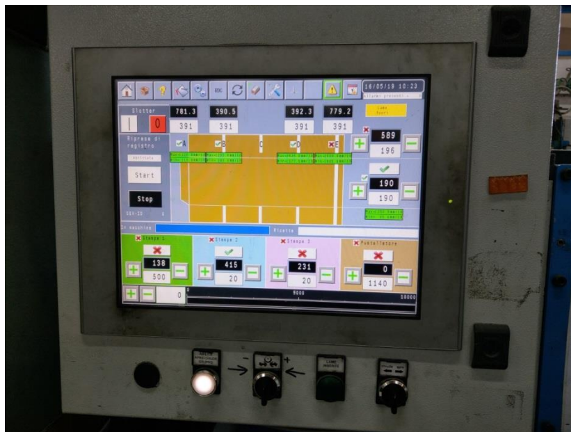
Slika 25: Sučelje slotera za unos mjera (Izvor: Autor)
