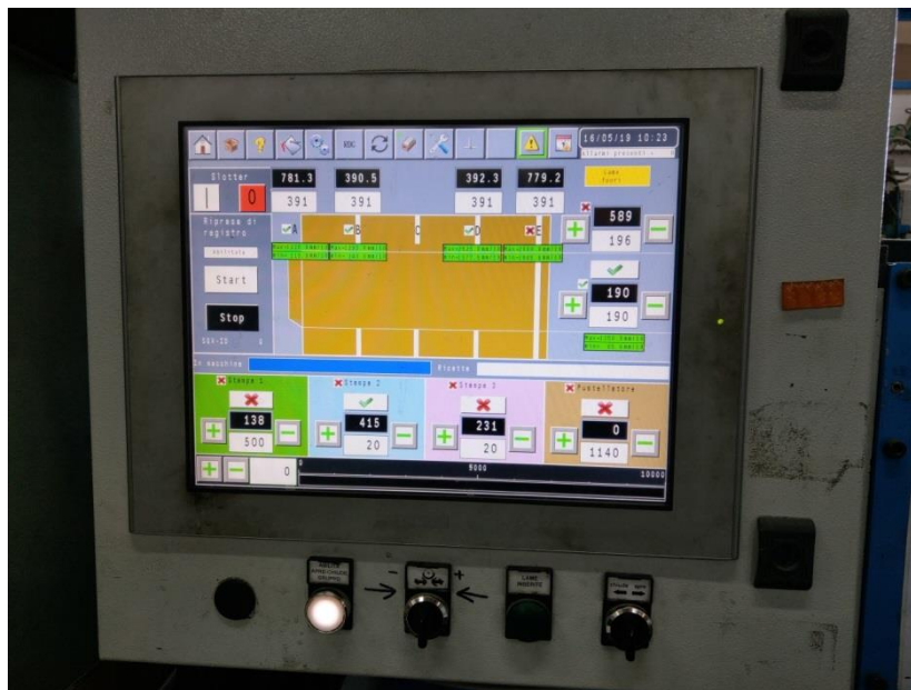
Slika 25: Sučelje slotera za unos mjera (Izvor: Autor)
