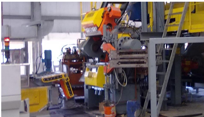
Slika 10 – Otvorena glava ekstrudera, ATCo. Egipat
