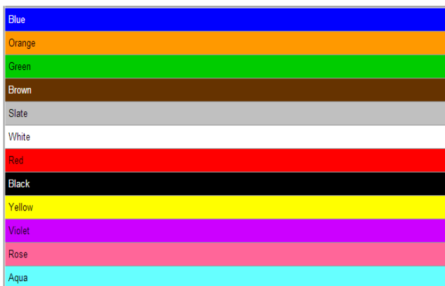
Slika 15: Kodiranje niti bojom u kabelu tvrtke Corning
