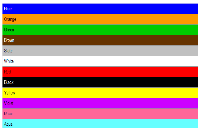
Slika 15: Kodiranje niti bojom u kabelu tvrtke Corning
