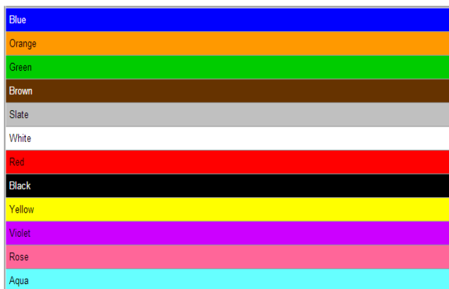
Slika 15: Kodiranje niti bojom u kabelu tvrtke Corning
