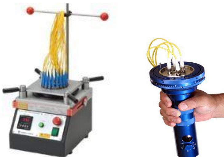
Slika 25: Uređaji za poliranje konektora
