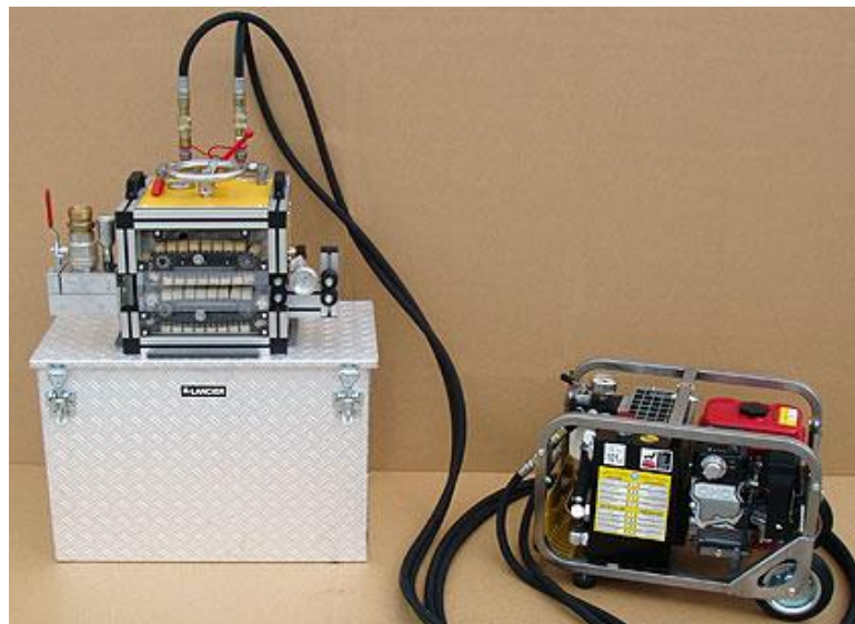
Slika 35: Hydrocat sa hidrauličkim modulom
