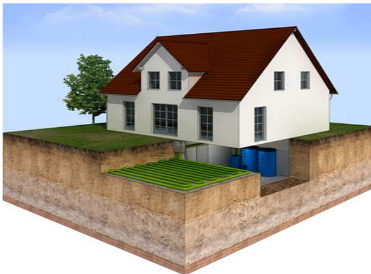
Slika 35. sustav zemljani kolektor, izvor www.mcsolar.hr
