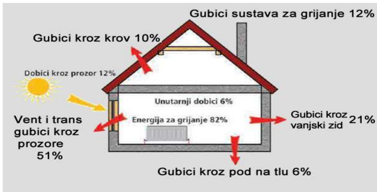
Slika 15. toplinski gubitci ,izvor www.fenix-tp.hr
