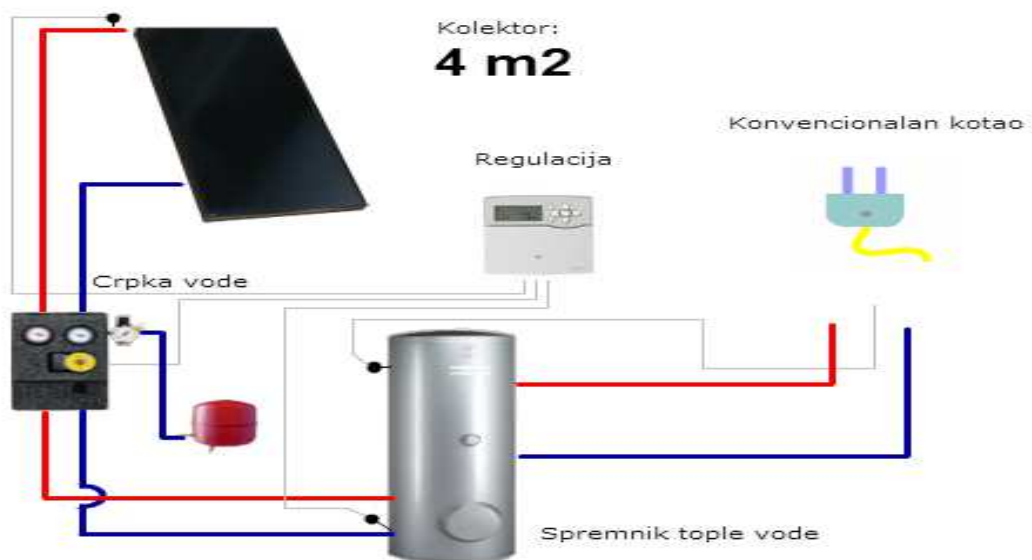
Slika 27. dimenzionirani sustav, izvor www.viessman.hr
