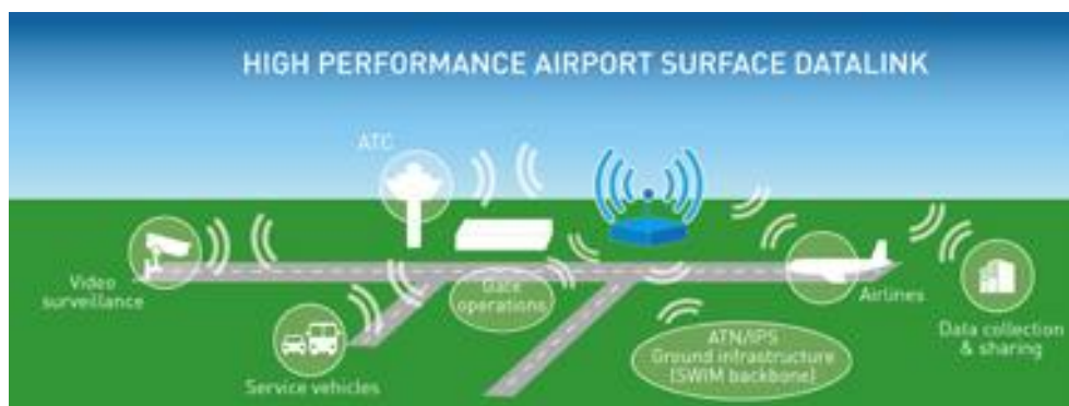
Slika 24. Način prijenosa podataka putem sustava AeroMACS [28]
