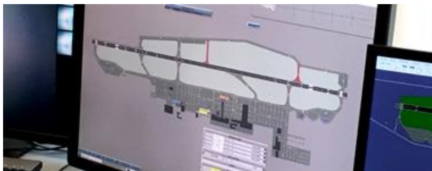
Slika 20. Prikaz sustava za usmjeravanje kretanja zrakoplova na aerodromu [28]
