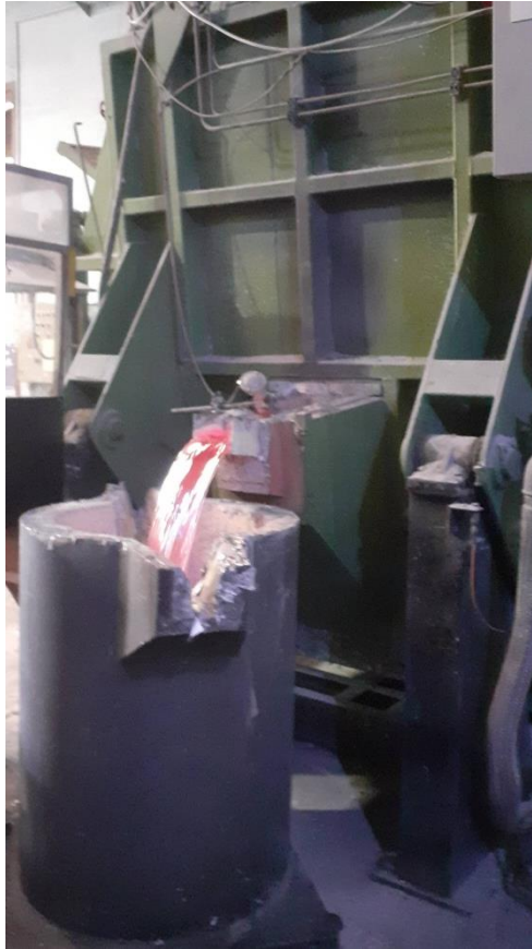
Slika 5. Izlijevanje taline iz peći za taljenje Botta u transportni lonac [Autor]
