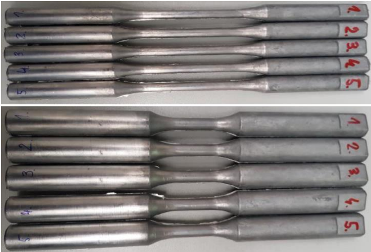
Slika 35. Epruvete za ispitivanje [Autor]
