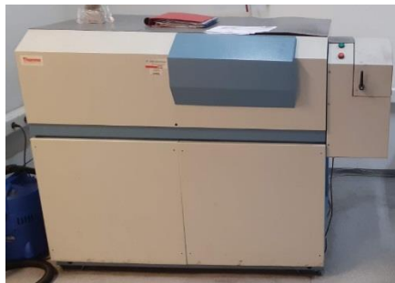
Slika 21. Spektrometar THERMO - ARL 3460 ADVANTAGE [Autor]
