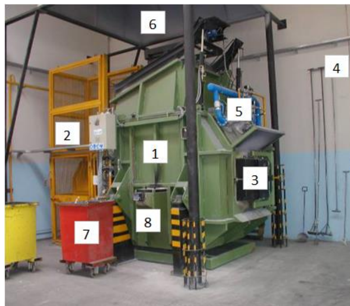
Slika 1. Peć Botta i prikaz glavni dijelova peći: 1. peć, 2. lift za ukrcaj transportnih kolica, 3. vrata za čišćenje peći, 4. pribor za čišćenje peći, 5. plamenici, 6. napa za dimne plinove 7. transportna kolica i 8. otvor za izlivanje slitine. [3]
