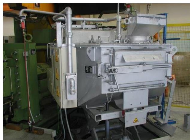
Slika 10. Peć za održavanje temperature taline [3]
