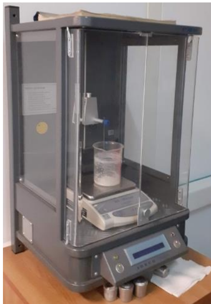
Slika 25. Uređaj za određivanje gustoće uzoraka [Autor]
