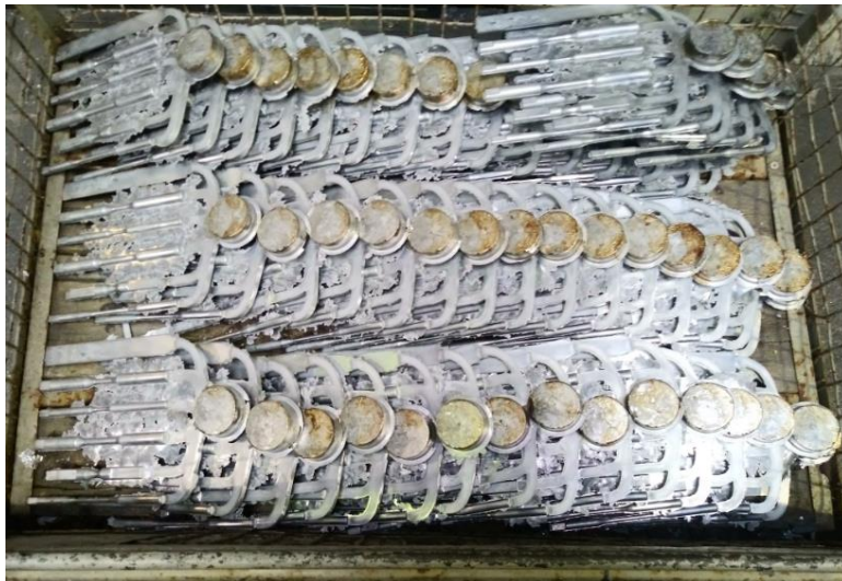
Slika 34. Sanduk sa odlivenim uzorcima za ispitivanje [Autor]
