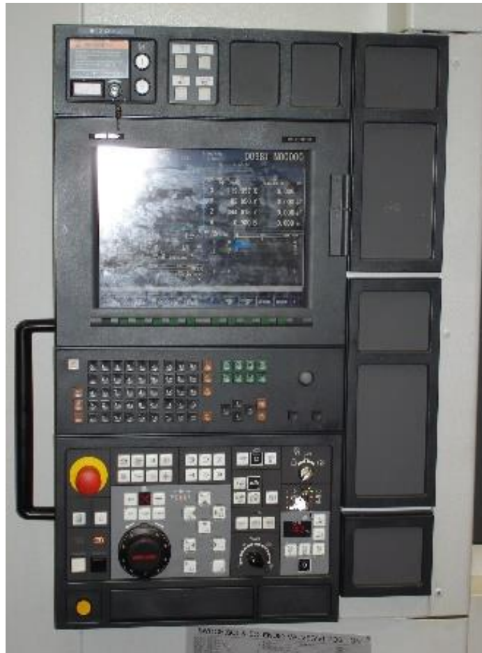
Slika 6.8 Upravljačka jedinica Fanuc MSG-5
