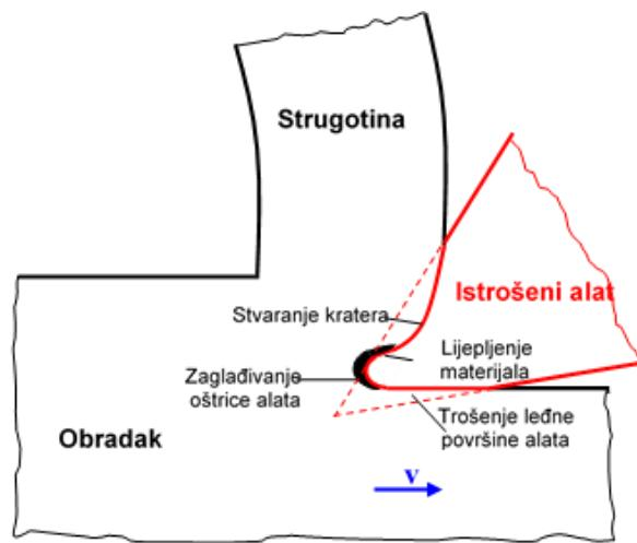
Slika 3.1 Površine trošenja alata [2]
