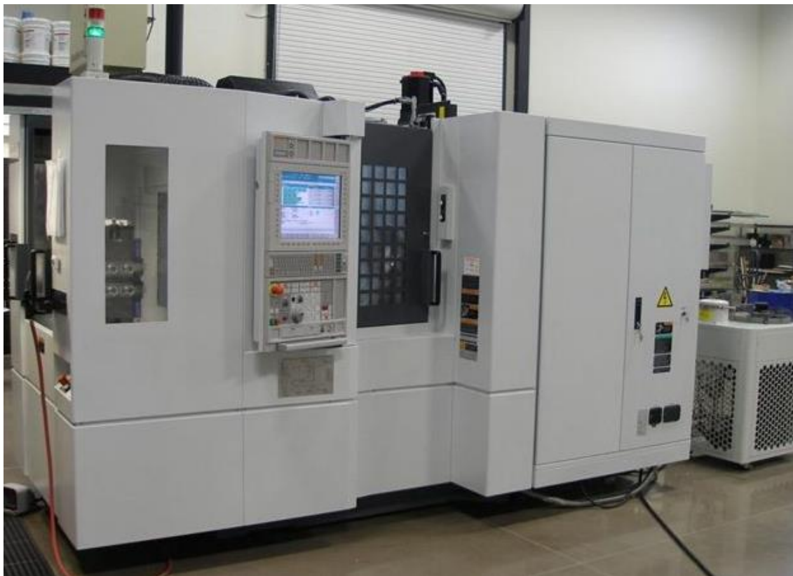
Slika 6.4 Obradni centar Mori Seki NH4000
