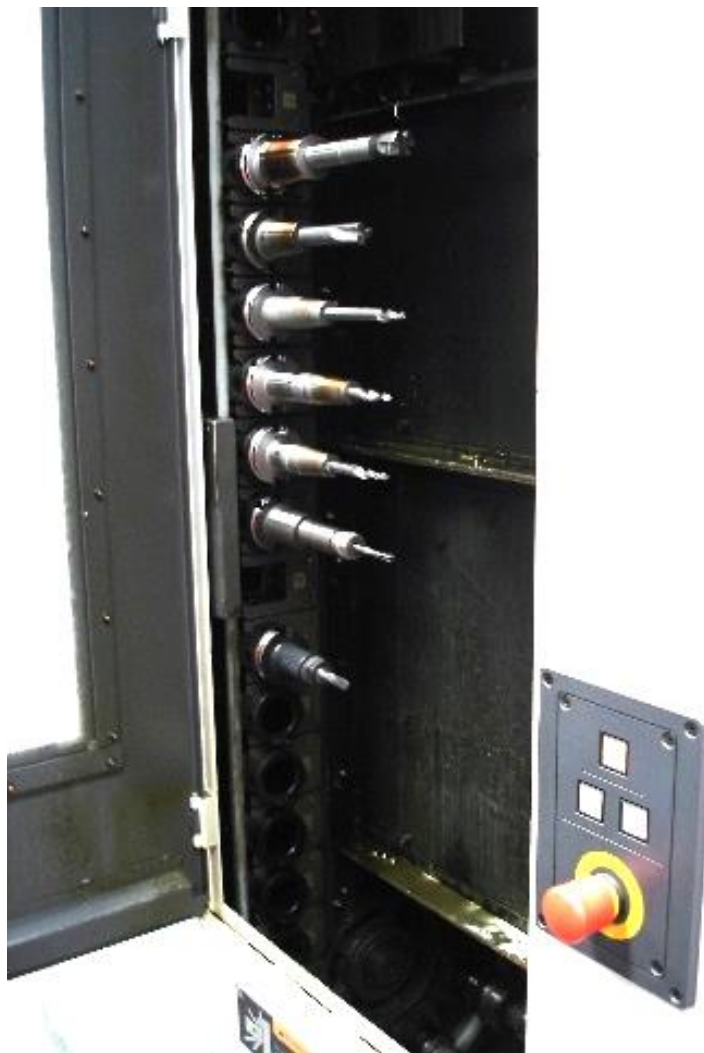
Slika 6.7 Spremište reznih alata
