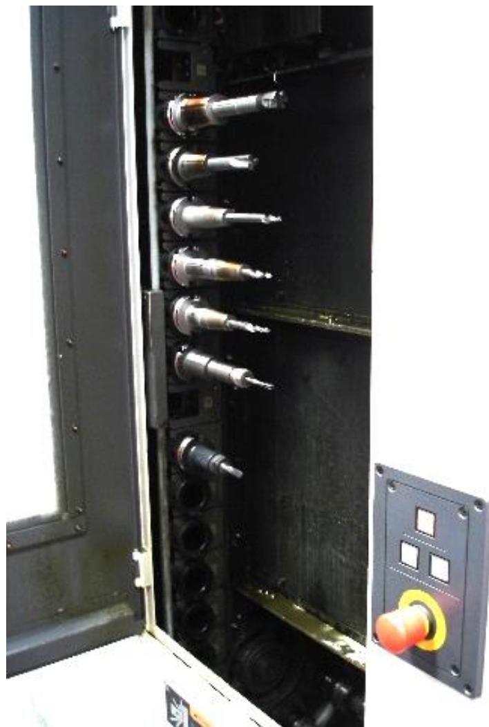
Slika 6.7 Spremište reznih alata
