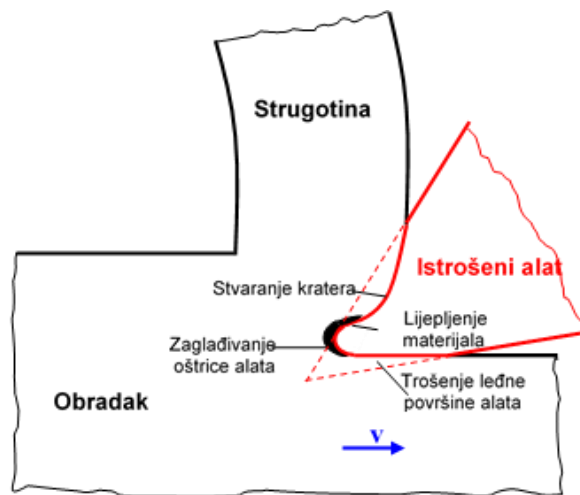
Slika 3.1 Površine trošenja alata [2]
