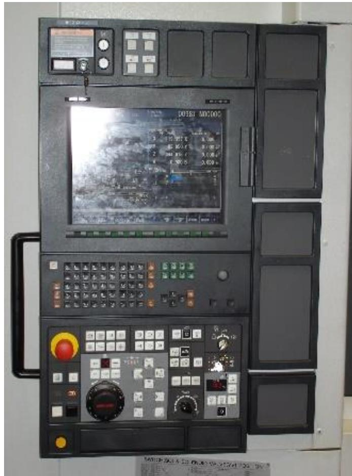
Slika 6.8 Upravljačka jedinica Fanuc MSG-5
