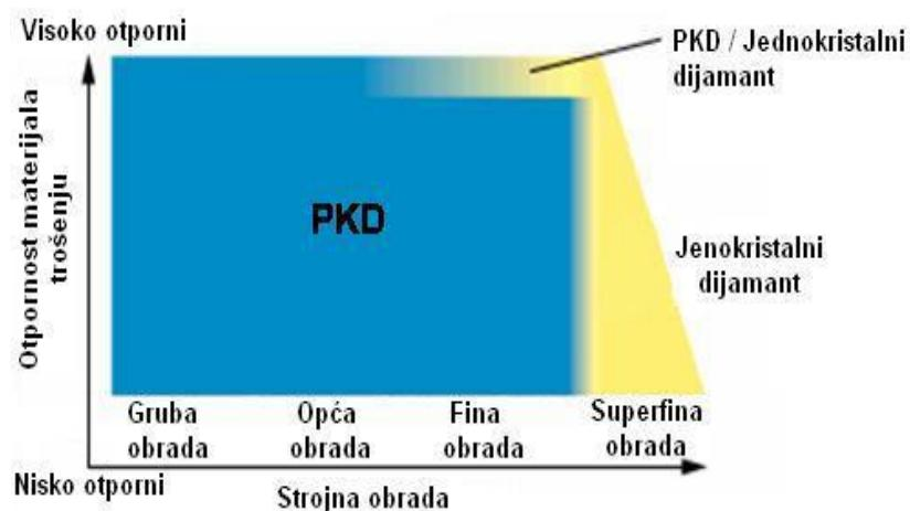
Slika 4.1 Otpornost PKD alata na trošenje [2]
