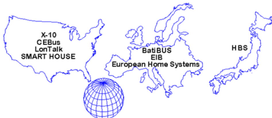
Slika 16. Prikaz korištenih protokola u kućnoj automatizaciji u svijetu
