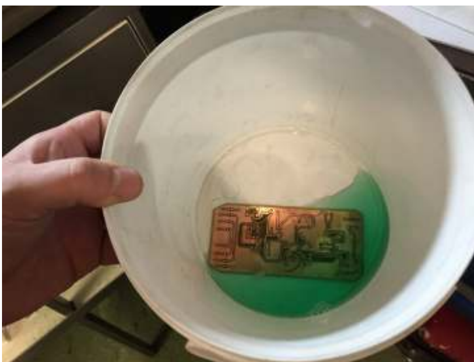
Slika 42. Materijal „BDM“ modula pri kraju procesa jetkanja
