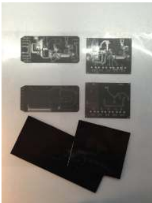
Slika 37. Film za razvijanje tiskanih pločica i materijal za njihovu izradu (izvor: autor, kolovoz, 2015.)
