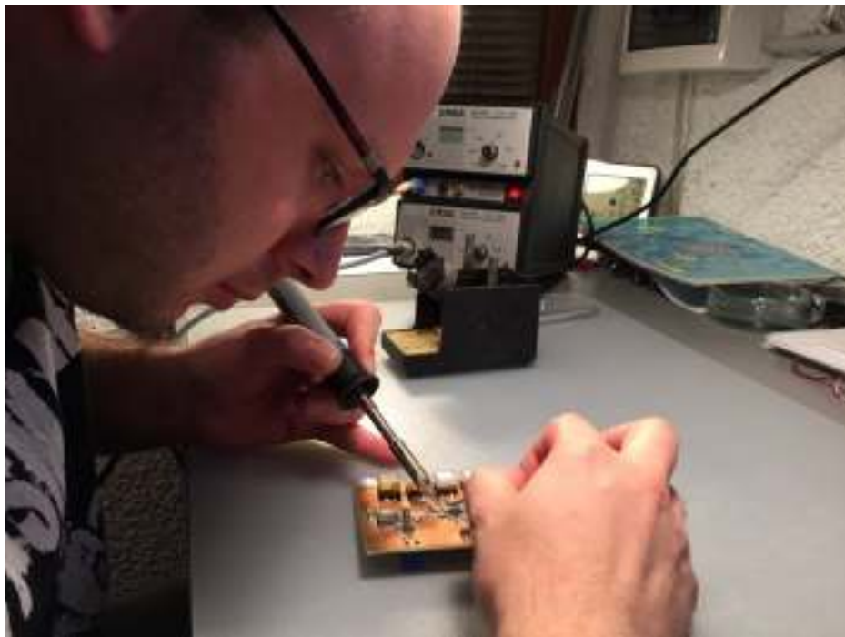
Slika 45. Proces lemljenja elektroničkih elemenata
