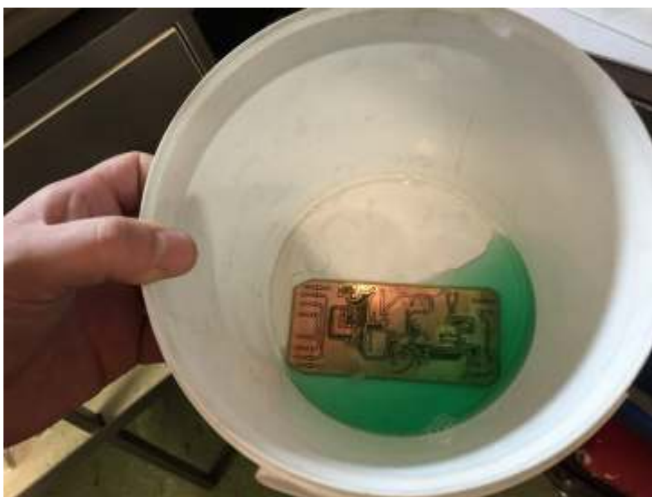
Slika 42. Materijal „BDM“ modula pri kraju procesa jetkanja
