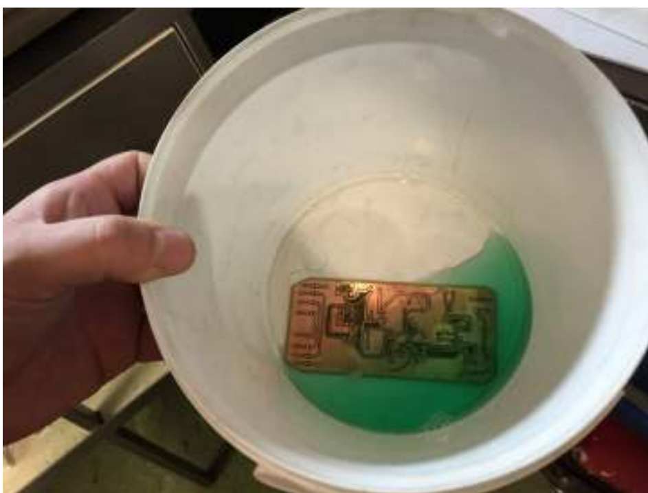
Slika 42. Materijal „BDM“ modula pri kraju procesa jetkanja
