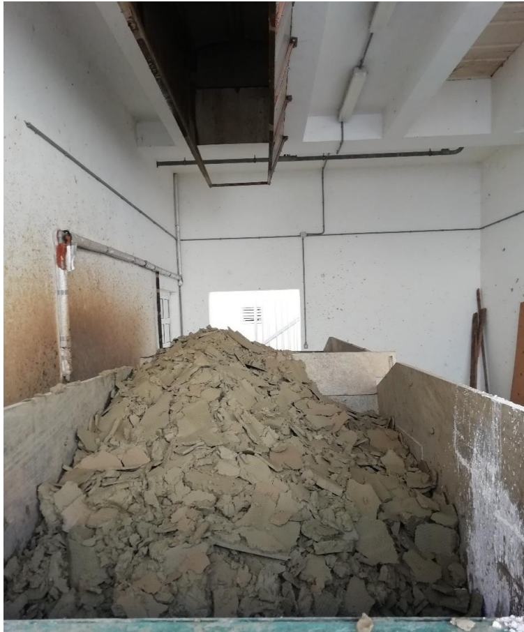
Slika 11: Filterski kolač mulja [Autor]
