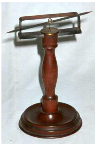
Slika 3: Uređaj za dokazivanje termoelektrične struje
