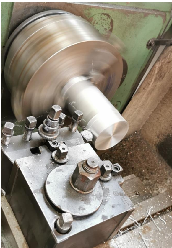
Slika 11: Izrada aluminijskog bloka
