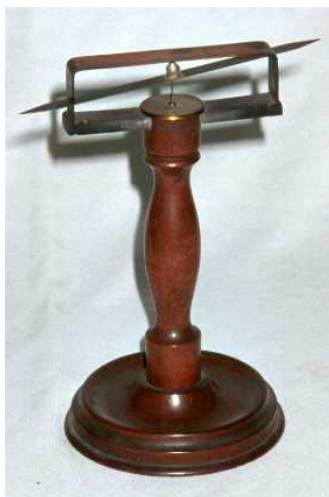
Slika 3: Uređaj za dokazivanje termoelektrične struje
