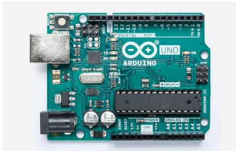
Slika 6. Mikrokontroler Arduino Uno
