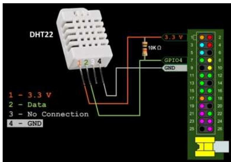
Slika 3. Senzor DHT 22
