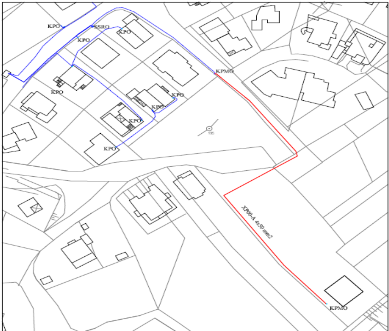
Slika 11. Priklučenje građevine kupca na niskonaponsku mrežu kada je potrebno ostvariti tehničke uvjete u mreži izgradnjom niskonaponske mreže (Izradio: Autor)
