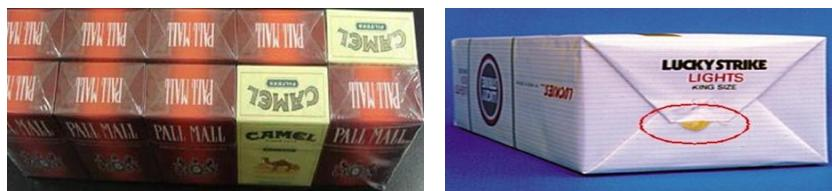
Slika 8. Primjer A (lijevo) i B (desno) greške šteke
