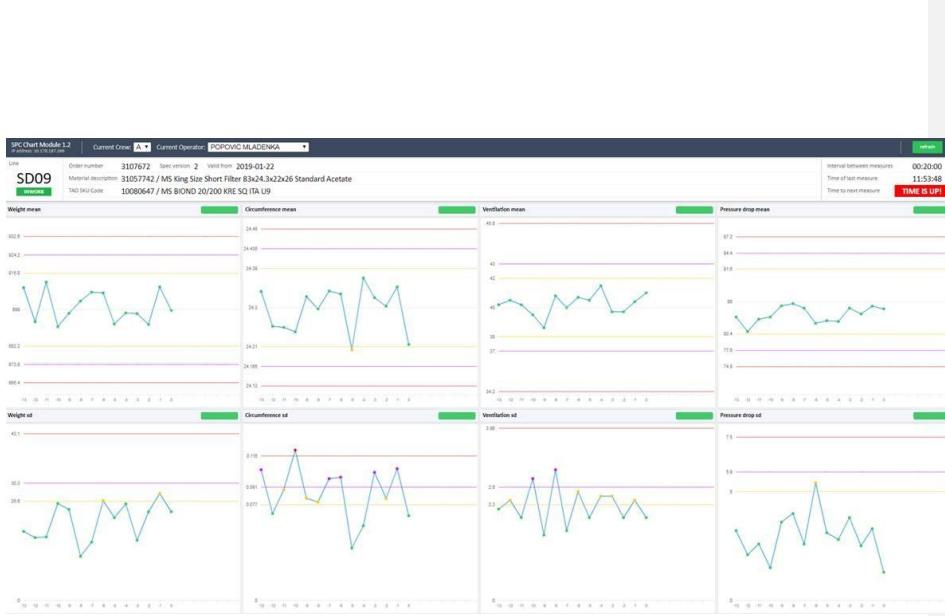
Slika 5. Prikaz mjerjenja fizikalnih parametara kroz LIMS sustav
