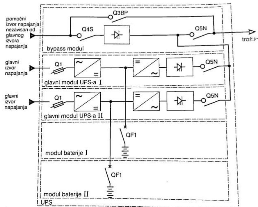
Slika 2. Prikaz sheme paralelno spojenih UPS sustava
