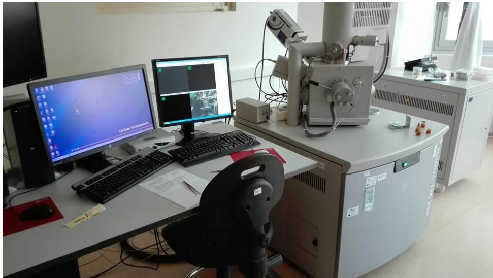
Slika 8. Pretražni elektronski mikroskop FEG QUANTA 250 SEM FEI s računalnom podrškom.
