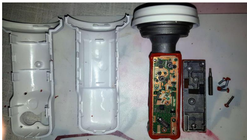
Slika 10: Unutarnji prikaz LNB-a
