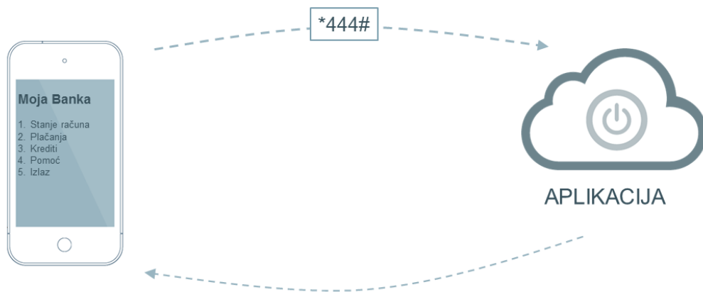
Slika 1. Primjer iniciranja USSD usluge zvanjem na kratki broj *444#
