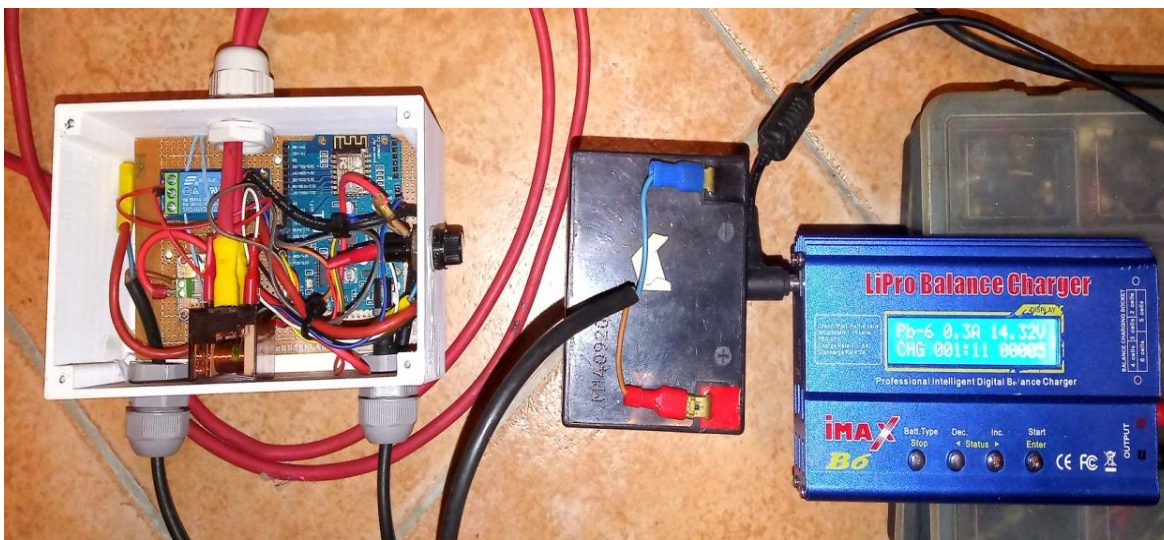
Slika 18:Funkcionalno ispitivanje sklopa
