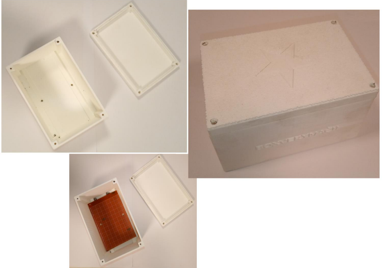
Slika 15: PLA prototip kućišta
