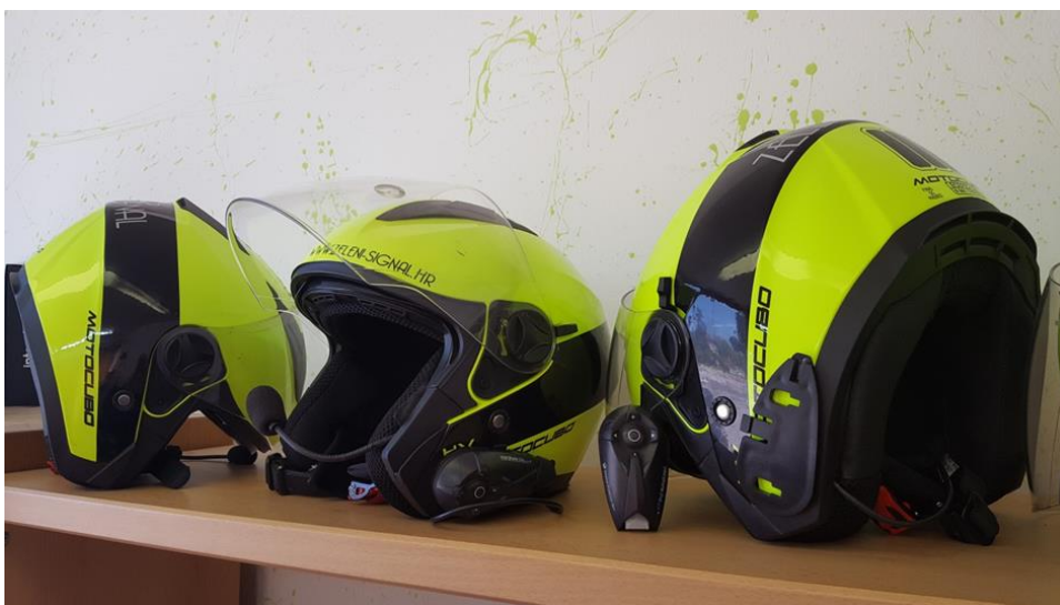
Slika 5. Kacige sa ugrađenim bluetooth instalacijama
