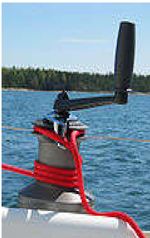
Slika10. Ručno vitlo za namatanje jedra
