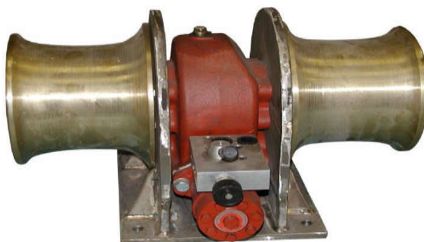
Slika 8. Prikaz priteznog vitla
