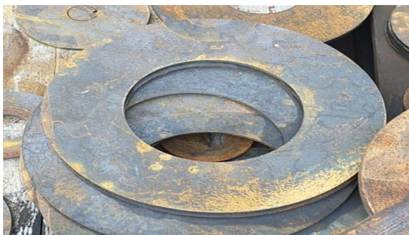
Slika 41. Tijelo prirubnice izrezano na stroju CNC plazma rezač 58
