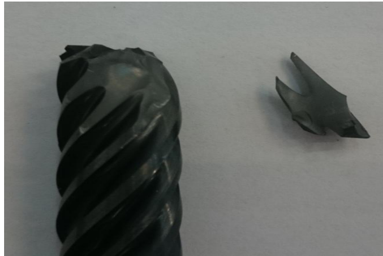
Slika 29. Oštećeno TPC glodalo 38
