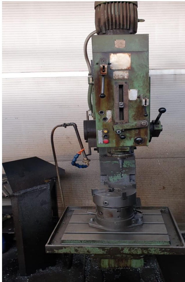
Slika 44. Stupna bušilica „Dalmastroj SB 4“ 61
