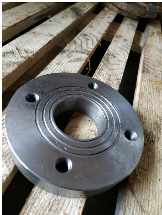
Slika 47. Prirubnica za pojačanje sa slijepim rupama 64
