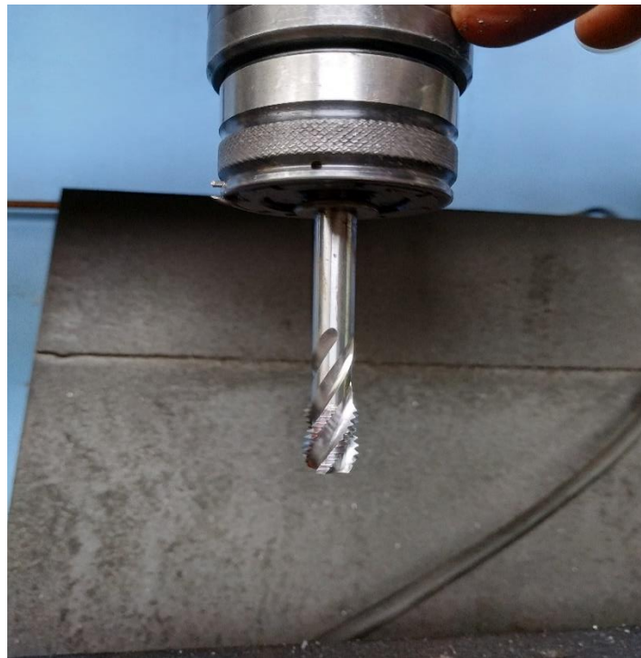
Slika 26. Glodalo za urezivanje navoja 35
