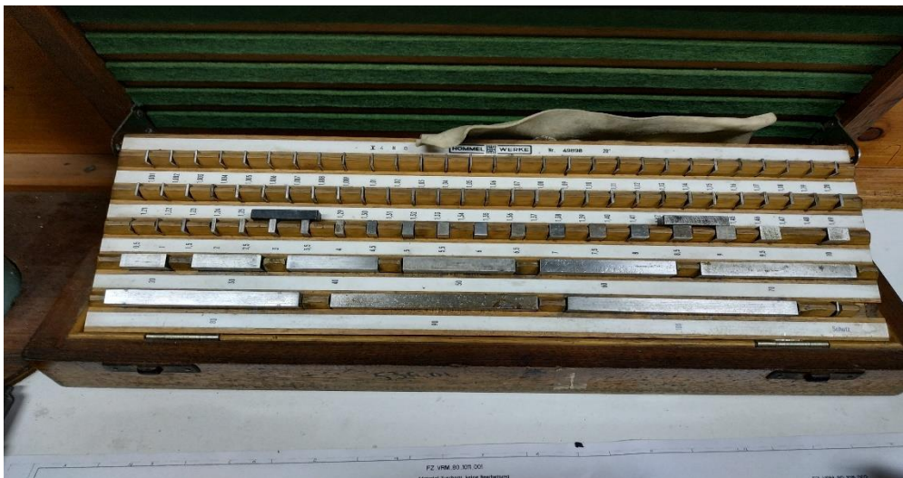
Slika 33. Mjerne pločice „etaloni“ 42
