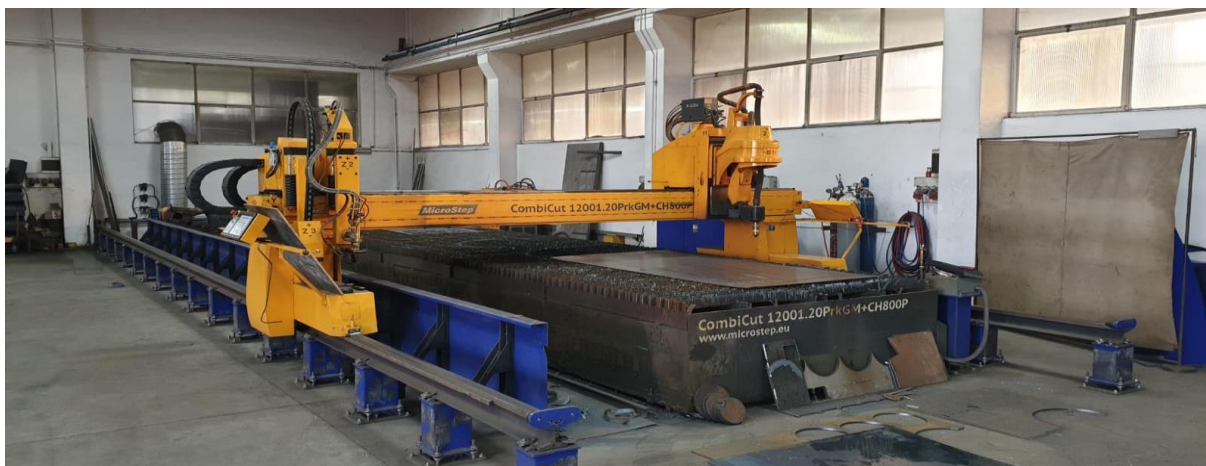
Slika 40. CNC plazma rezač „Micro Step: Combi Cut 12001“ 57
