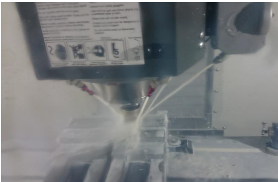
Slika 36. Primjena SHIP-a pri obradi odvajanjem čestica 45
