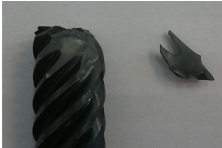
Slika 29. Oštećeno TPC glodalo 38
