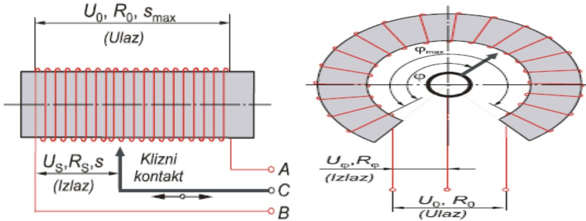
**Slika 14:** Potenciometarski senzor za mjerjenje linearnog i kutnog pomicanja [4]
