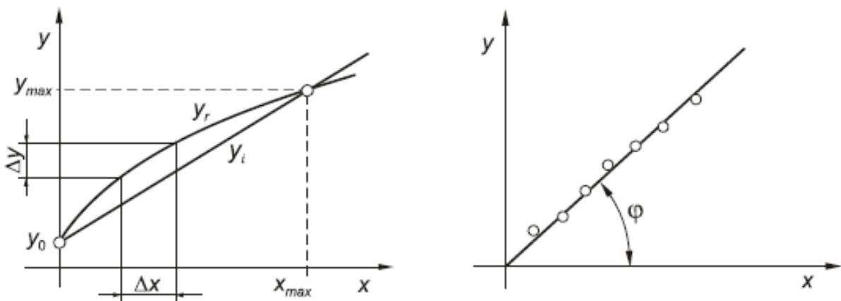
**Slika 3:** Statičke karakteristike: nelinearna (realna  $y_r$ ) i idealizirana  $y_i$  statička karakteristika, aproksimacija izmjerena vrijednosti
