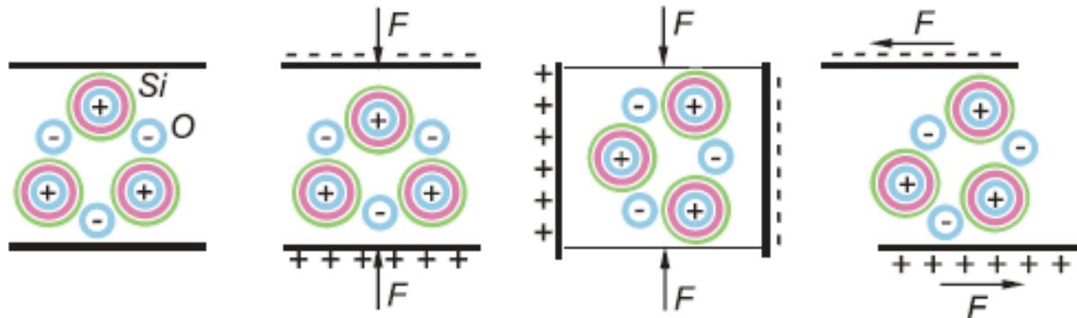
*Slika 9: Piezoelektrični efekt kod kvarca [4]*
