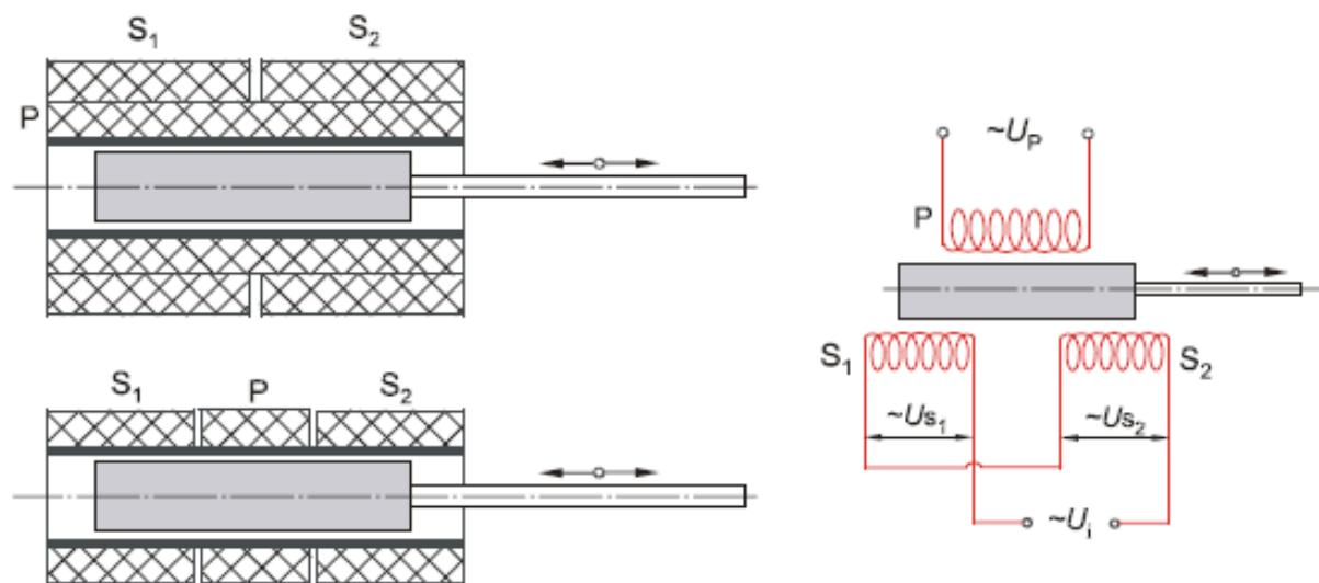
**Slika 8:** LVDT senzor – konstrukcijska izvedba, shematski prikaz [4]
