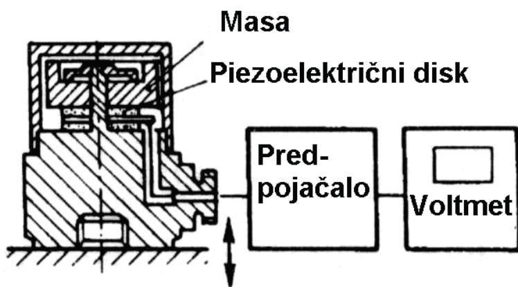
*Slika 10: Piezoelektrični akcelerometar [3]*
