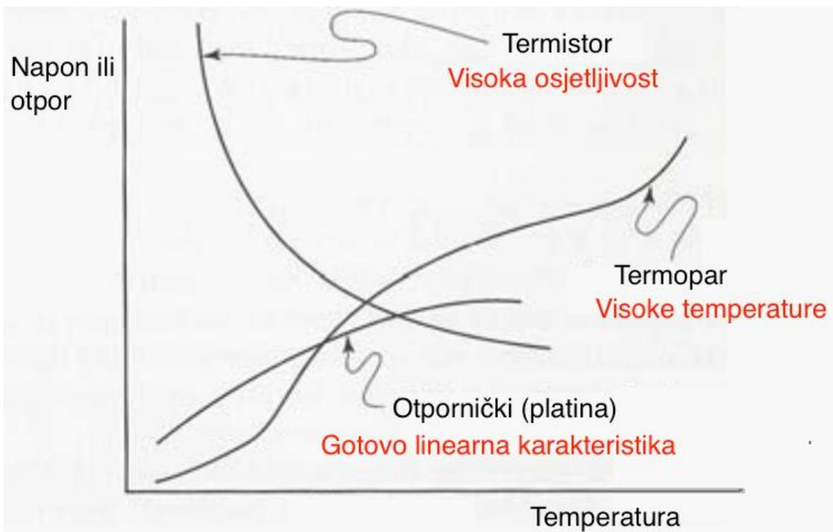
**Slika 20:** Gruba usporedba različitih tipova senzora [5]
