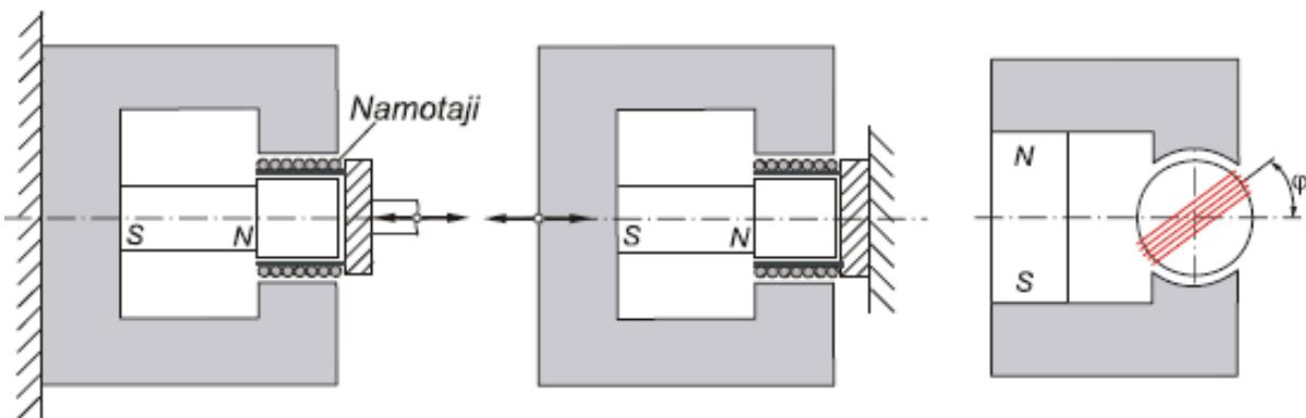
**Slika 4:** Indukcioni senzori – s pokretnim solenoidom, s pokretnim magnetom, za mjerjenje kutne brzine [4]
